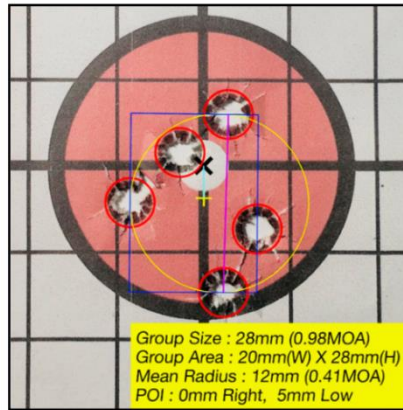
圖十 作者以國造 T93K1 狙擊槍於 100 公尺射擊 5 發彈著群測量範例
