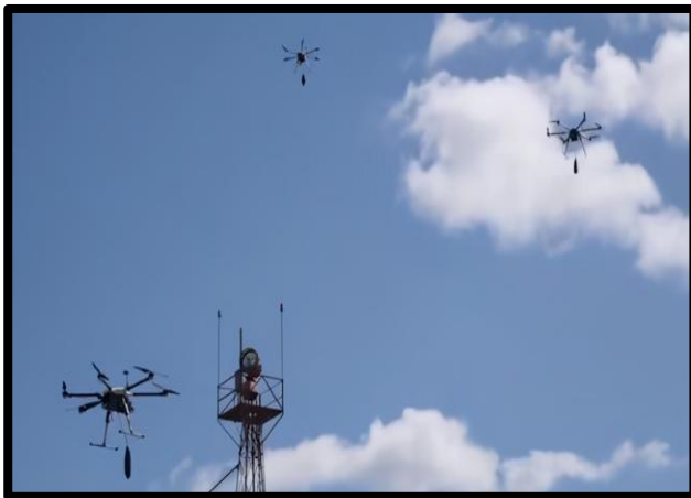
圖 11-無人機蜂群吊掛補給品
