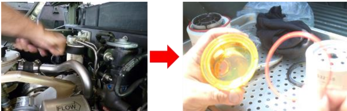
圖18 旋下內部燃油過濾水分分離器
