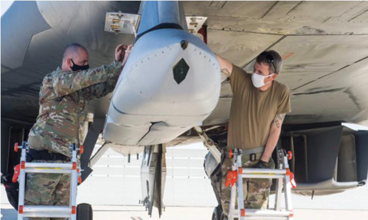
美空軍非匿蹤 B-1 高度依賴長程遙攻精準導引彈藥來提高戰場存活率。加州愛德華(Edwards)空軍基地的兵器維護士，正將聯合空對地遙攻飛彈(JASSM)掛載至B-1B槍騎兵(Lancer)轟炸機的外部掛點。(Source: USAF/Joshua Miller)
