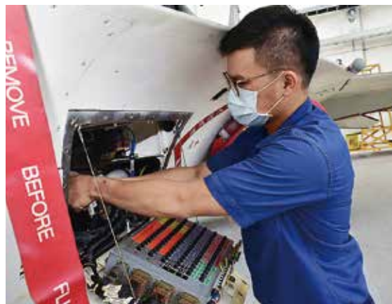
王上士安裝電瓶、再次檢查電路線束與接頭，為飛機執行最周密的檢查。
