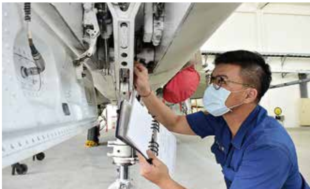
王上士隸屬週檢分隊，負責執行廠內機體維修保養，圖為他在檢查前起落架、輔助支撐、轉向機構本體等零附件。
