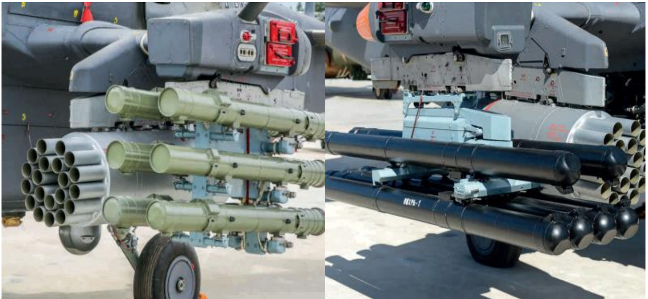
圖六 機載 S-8 航空火箭彈、Ataka 導引式飛彈(左)及 Vikhr-1 導引式飛彈(右) 資料來源：同註 13。
