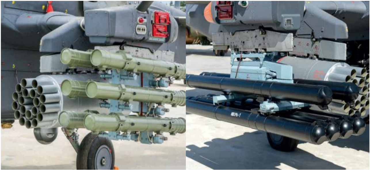
圖六 機載 S-8 航空火箭彈、Ataka 導引式飛彈(左)及 Vikhr-1 導引式飛彈(右)
