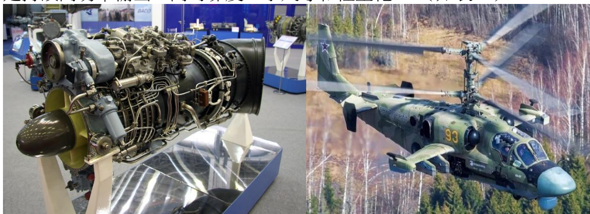
圖三 TV3-117VMA 發動機(左)及 Ka-52K 水平滯空(右)示意圖
