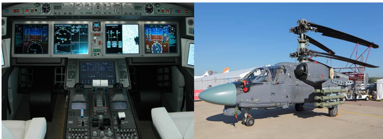
圖二 Ka-52K 攻擊直升機雙人座艙(左)及折疊式主旋翼(右)
