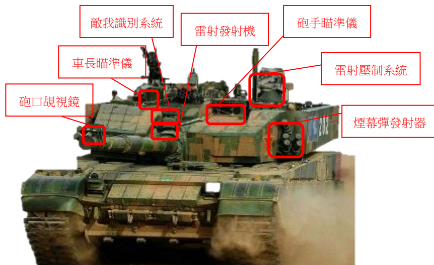
圖一：ZTZ-99A 戰車各部名稱配置圖(一)
