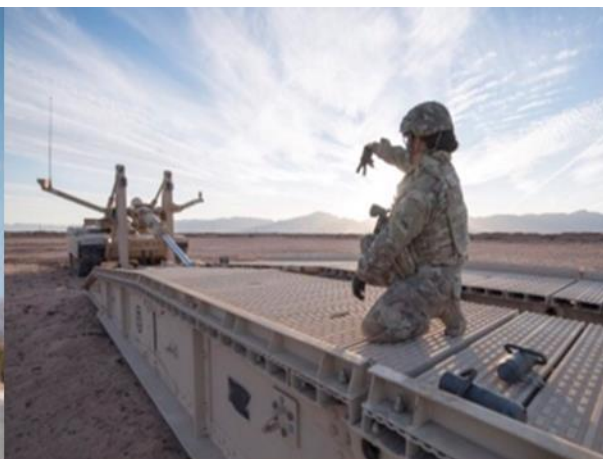
圖6 JAB架橋車橋樑展開及收回測試
