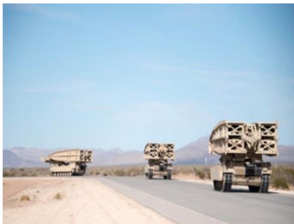
圖5 JAB架橋車動力測試
