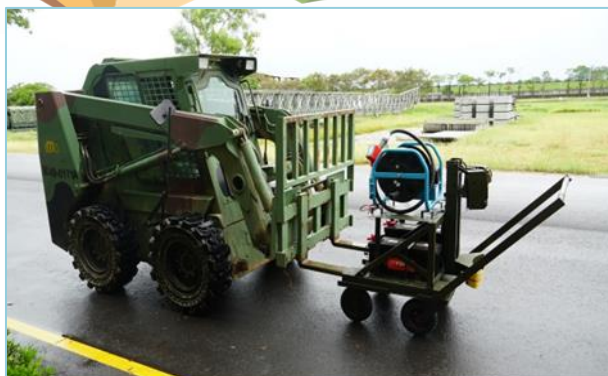
圖24 安裝加油設備組
