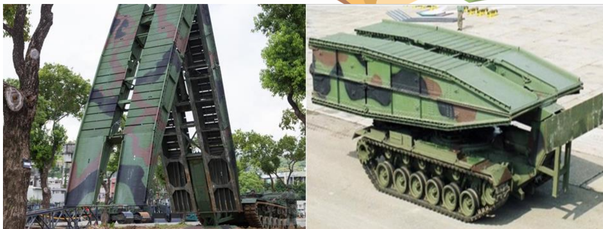
圖1 M48A5履帶機動橋
