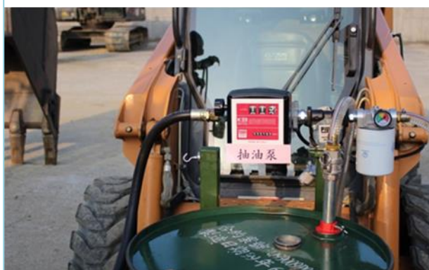
圖31 貨叉組裝及油桶固定作業2 資料來源：作者自行拍攝。
