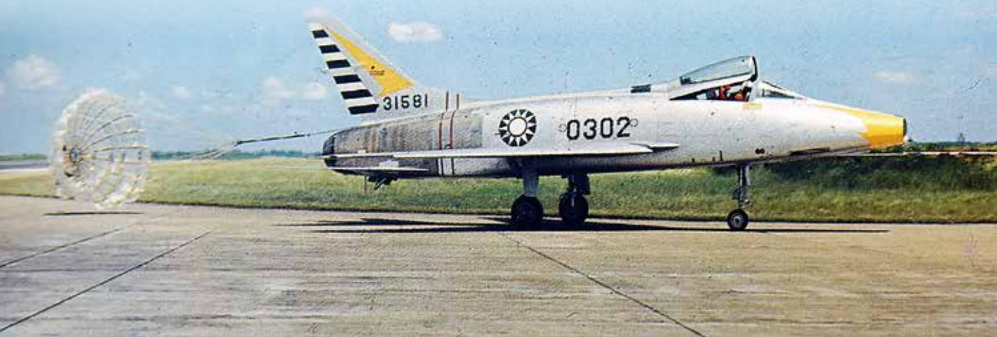
下圖為F-100型機拉出阻力傘減速畫面。
