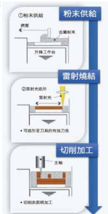
圖1. 粉床式金屬積層製造
