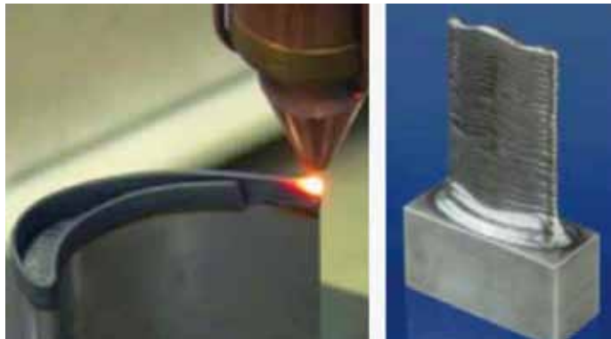
圖3. 噴粉式金屬積層製造過程及成品
