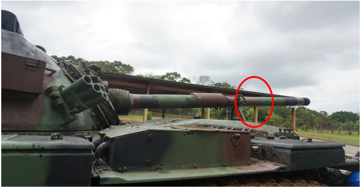
圖 17、使用行軍固定鎖將砲管固定
