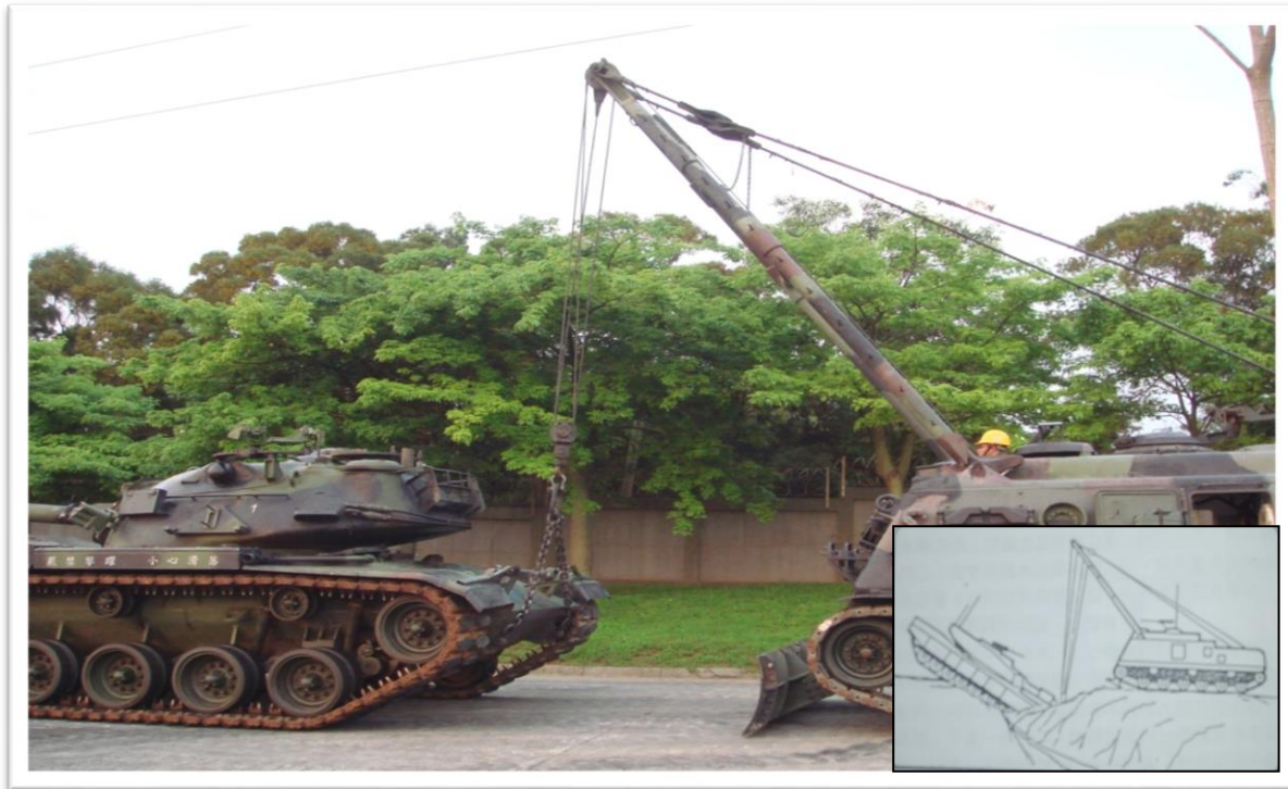
圖 14、吊舉救濟法作業原理
