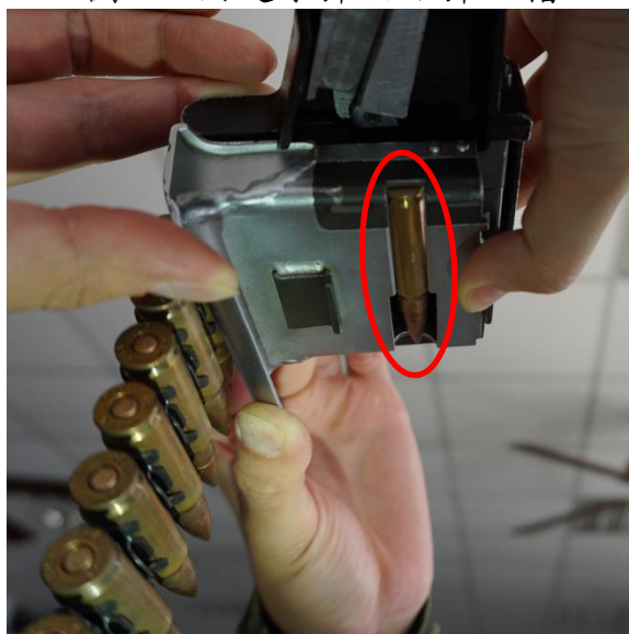
圖 12-固定子彈於給彈凹槽
