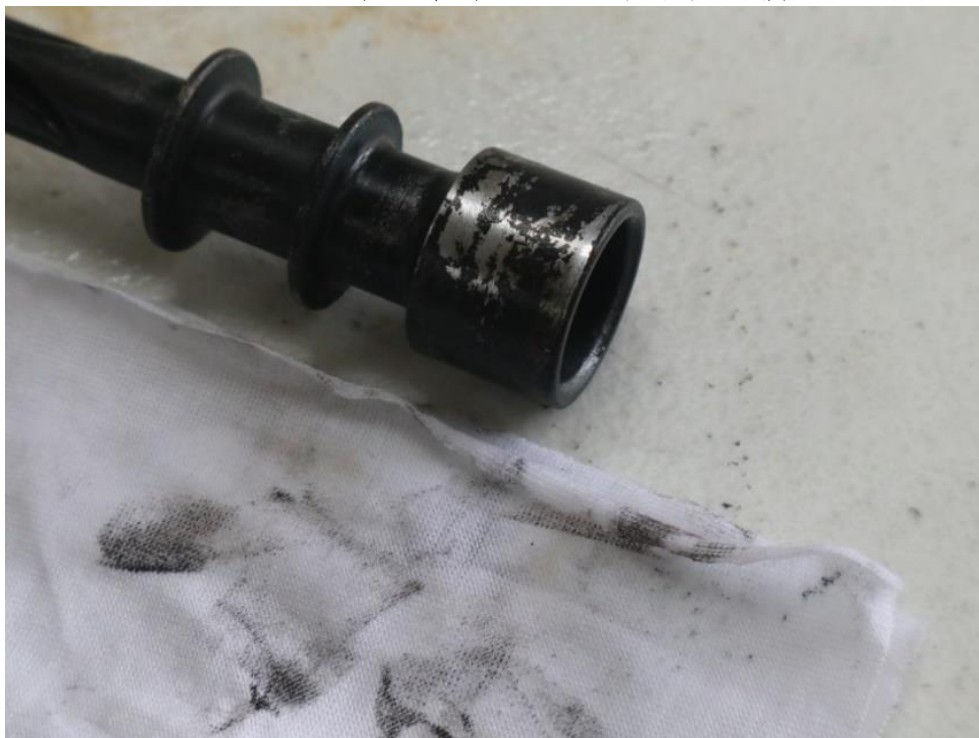
圖 36-使用擦槍布擦拭活塞部件表面積碳
