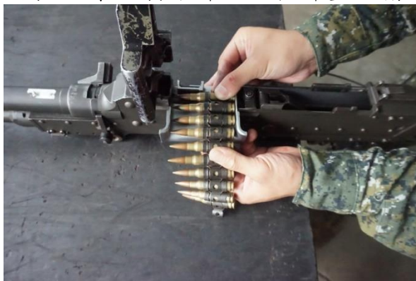
圖 11-第 1 發子彈位於托彈盤凹槽
