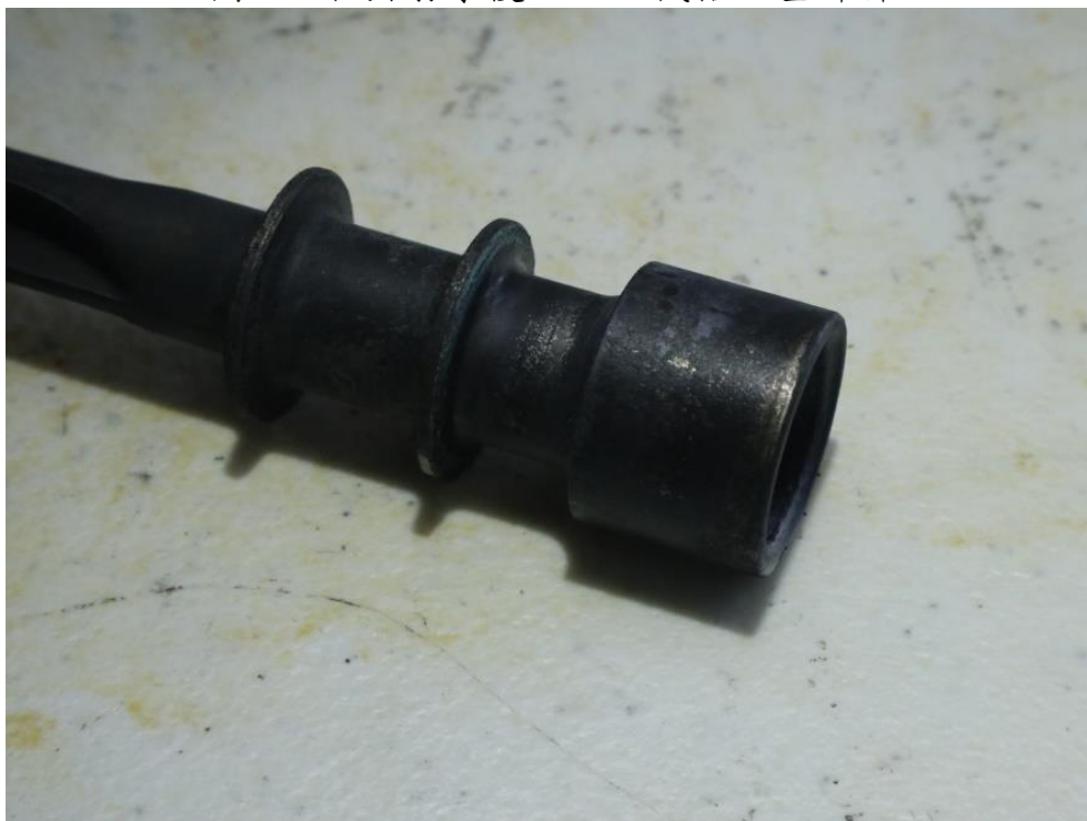
圖 33-取出射擊後 M240 機槍活塞部件
