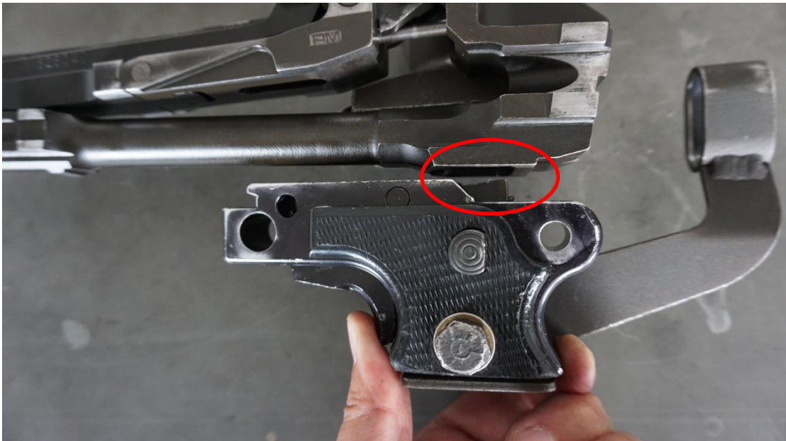
圖 20-按壓扳機時阻鐵後端脫離阻鐵槽
