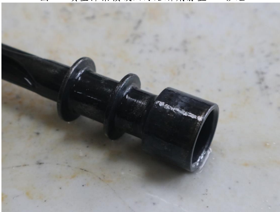
圖 35-噴塗彈藥積碳油汙溶解劑靜置 10 秒鐘
