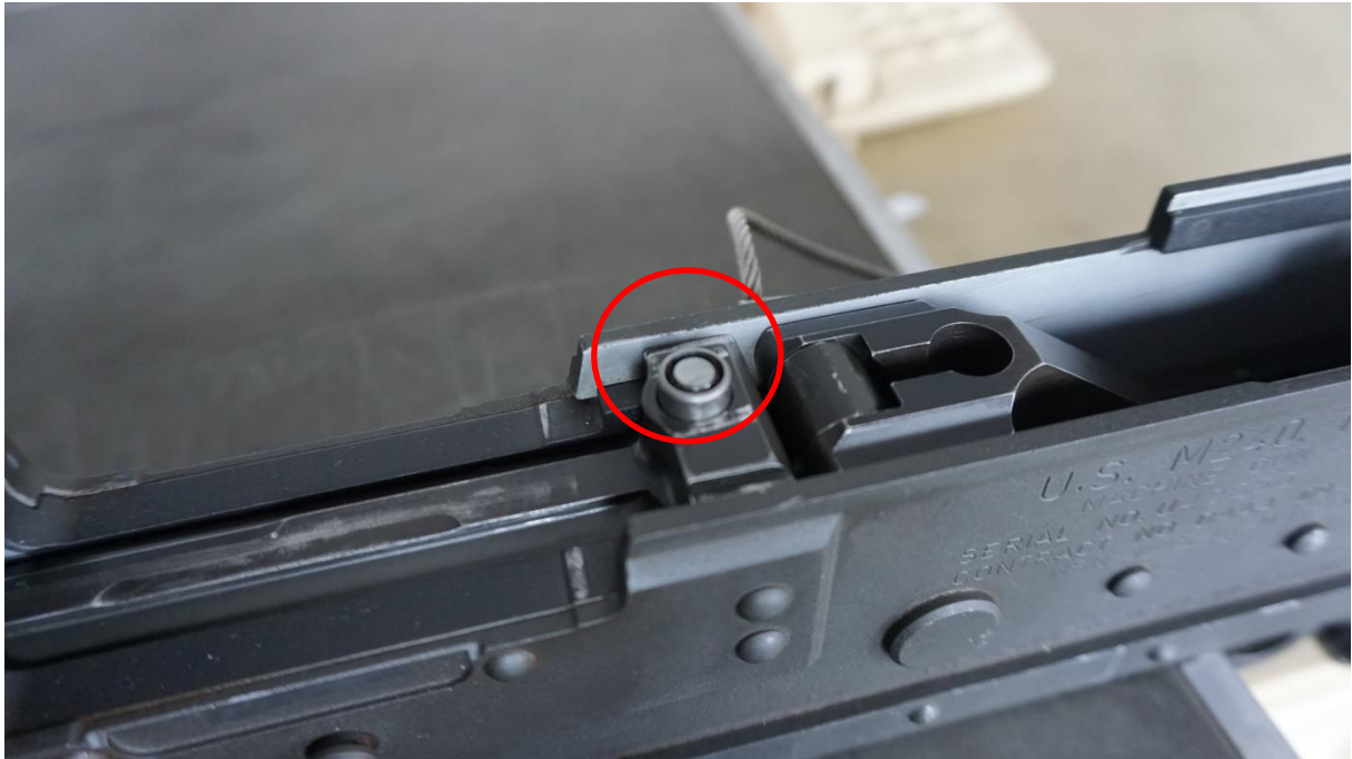
圖 15-槍機總成上端滑輪
