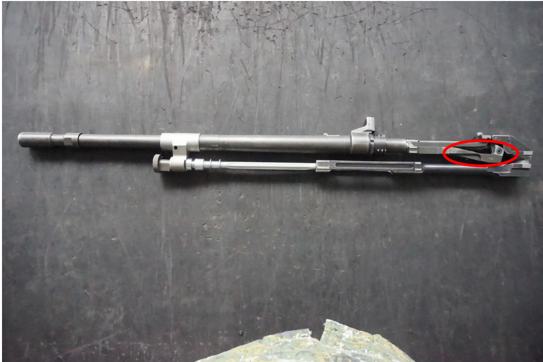
圖 23-支臂樑前端形成閉鎖
