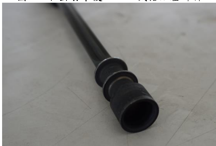
圖 29-取出射擊後 M240 機槍活塞部件
