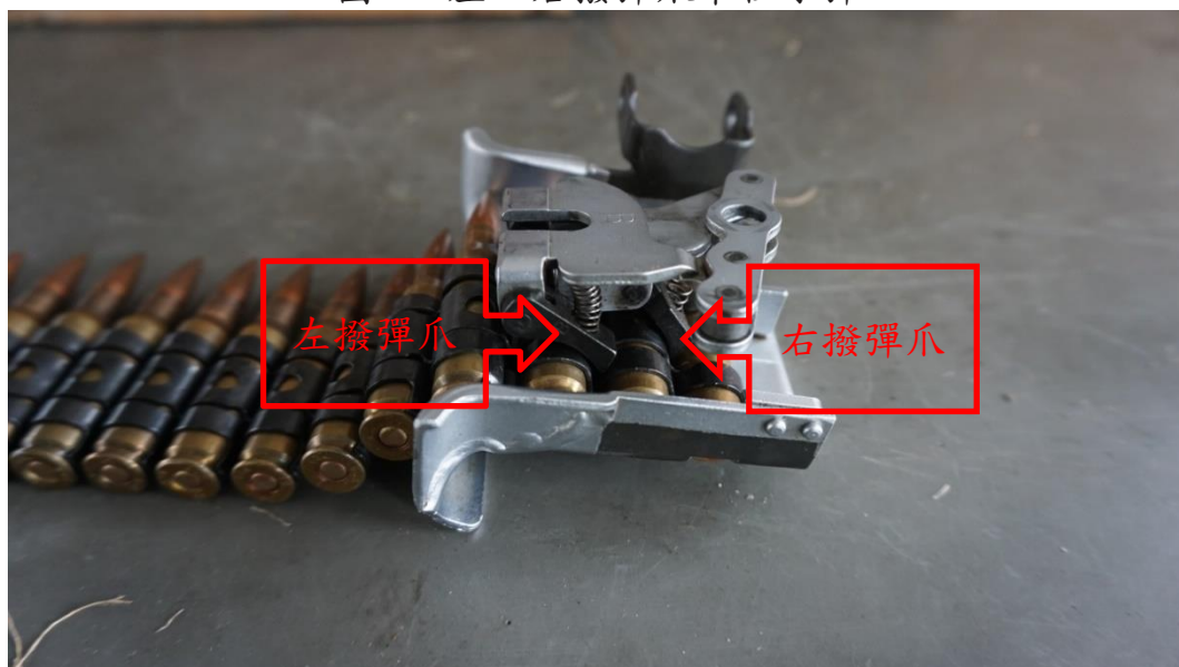
圖 14-左、右撥彈爪卡住子彈
