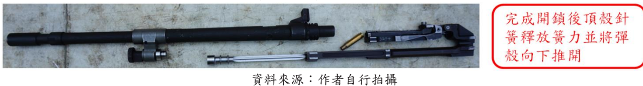
圖 26-頂殼針簧釋放簧力並將彈殼向下推開
