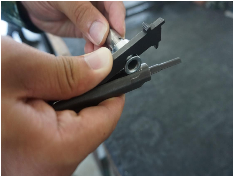
圖 40-清除瓦斯缸管外部環狀溝槽積碳
