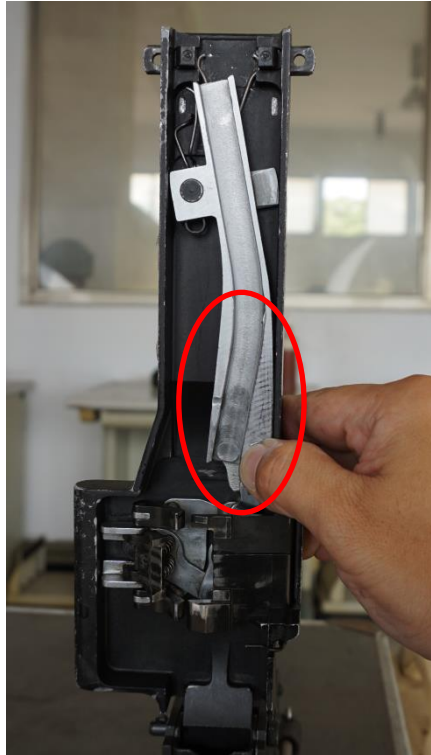
圖 17-滑輪導桿前端向右
