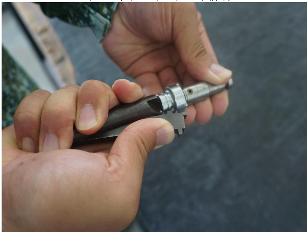
圖 38-清除瓦斯缸管內部積碳
