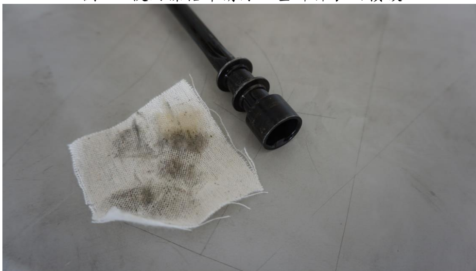
圖 31-使用擦槍布清除活塞部件表面積碳
