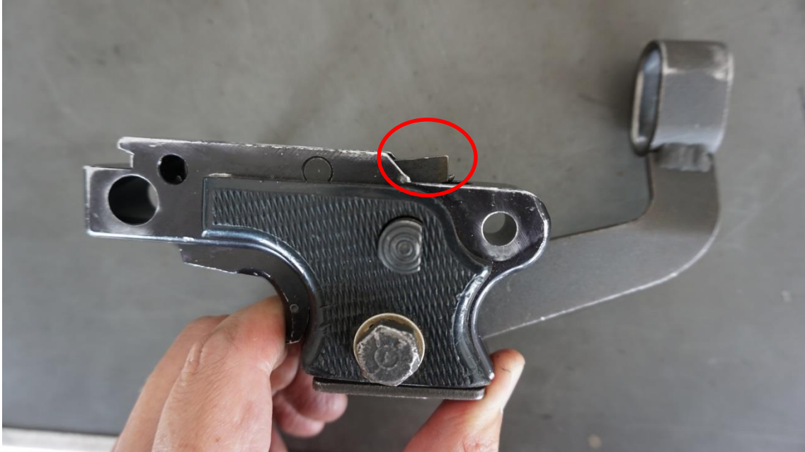
圖 19-按壓扳機時阻鐵後端向下
