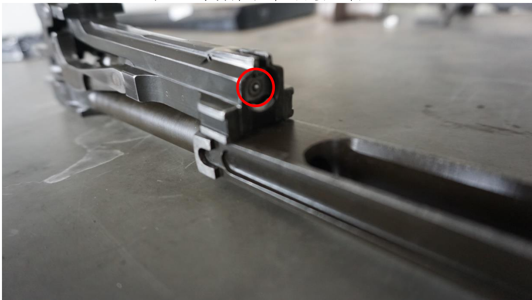
圖 24-門鎖桿下降迫使撞針突出
