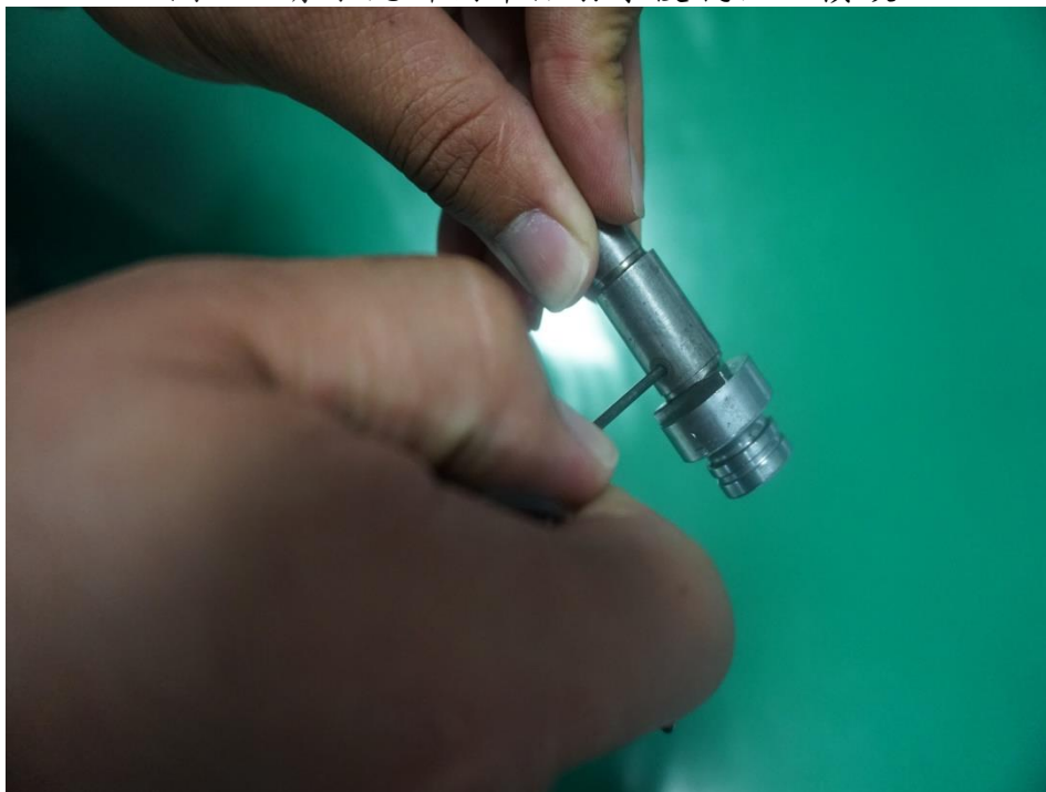
圖 44-清除瓦斯調節器射擊後氣孔之積碳
