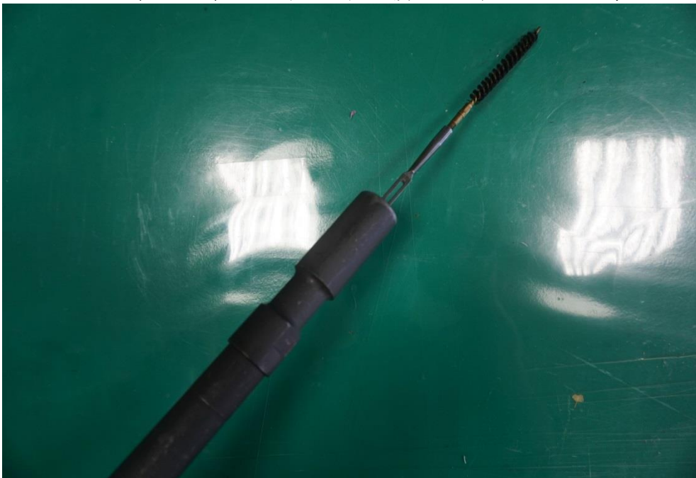
圖 46-清除射擊後槍管膛線之積碳及彈丸留下金屬物
