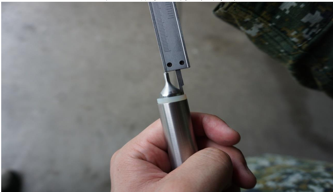
圖 47-游標卡尺測量前端擊針
