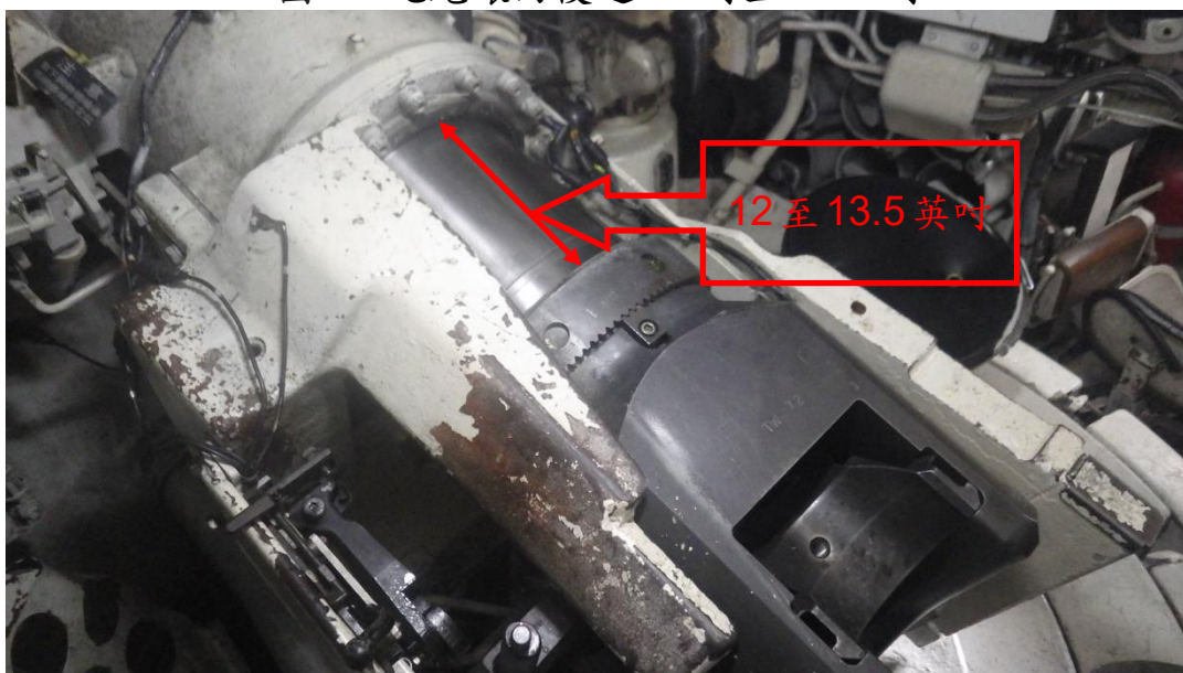
圖 20-砲尾環向後退 12 吋至 13.5 吋
