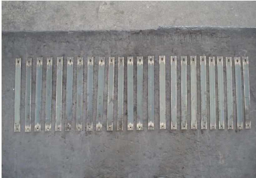
圖 16-操作軸內部 24 片彈簧葉片
