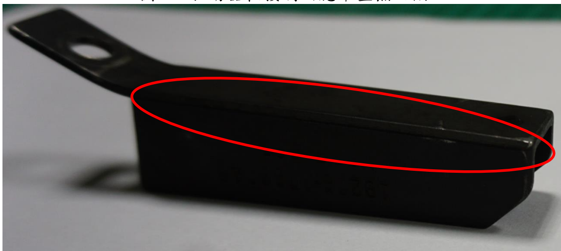
圖 58-驅動器軸接觸面應平整無凹陷
