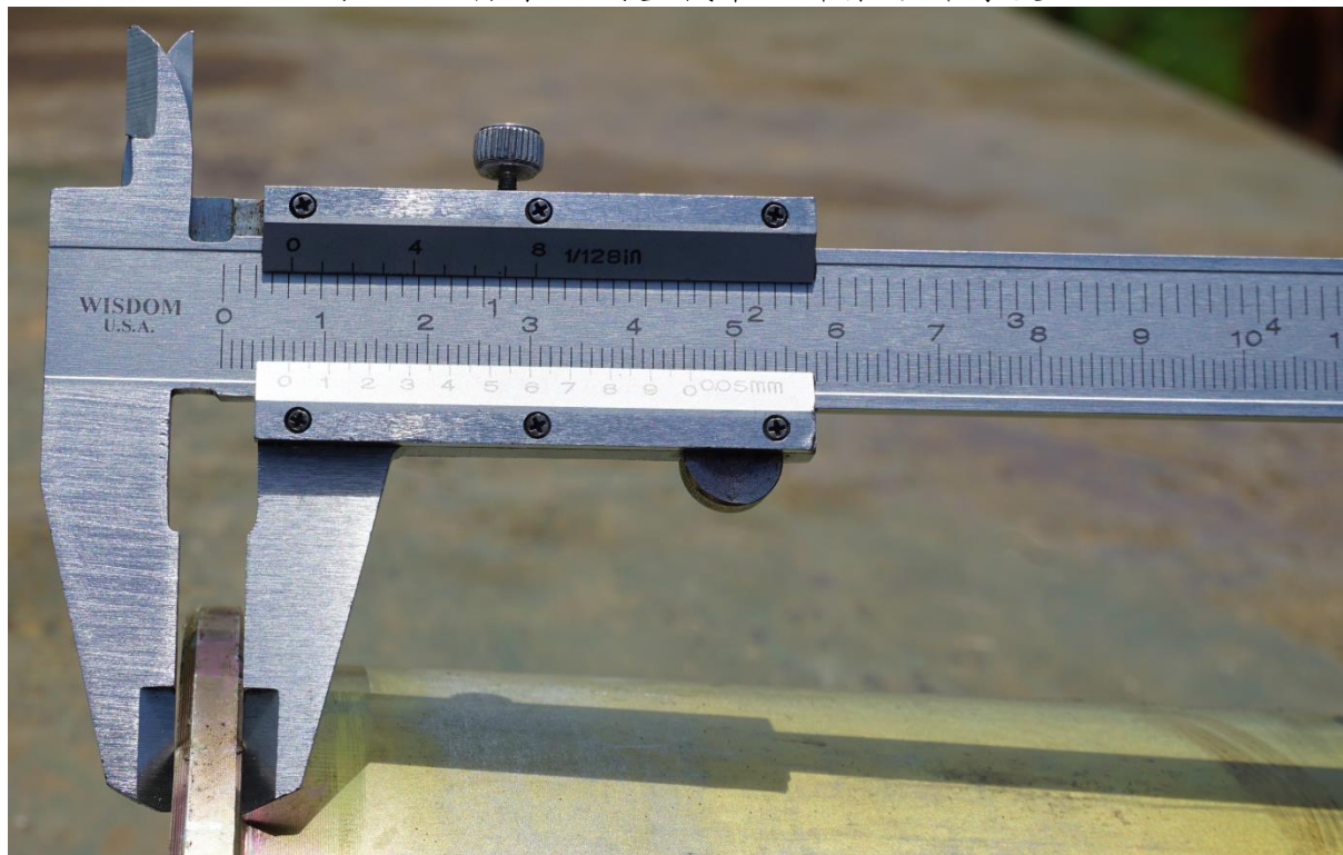
圖 51-游標卡尺測量戰車砲彈藥底部厚度
