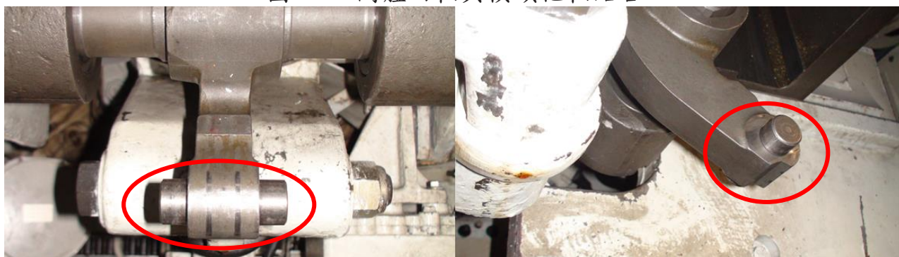
圖 46、門體曲軸與橫頭樞軸結合
