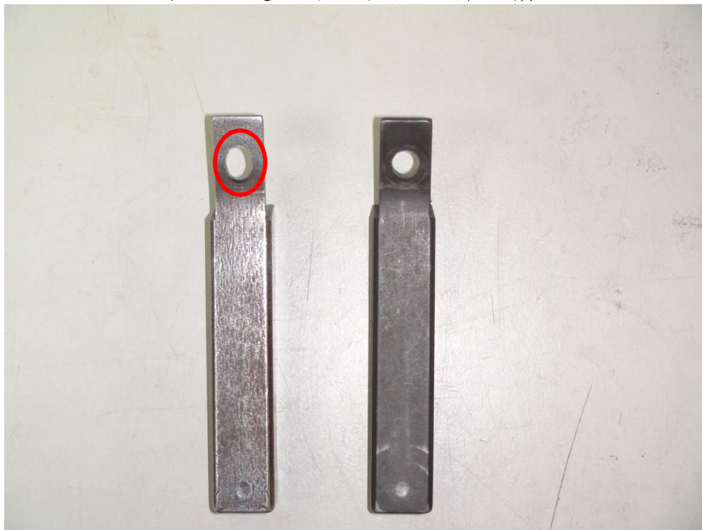
圖 45-左邊驅動器螺絲孔已嚴重擴孔
