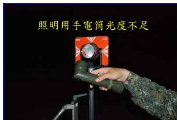
圖 16 手電筒照明反射稜鏡光度不足，夜間難以辨識
