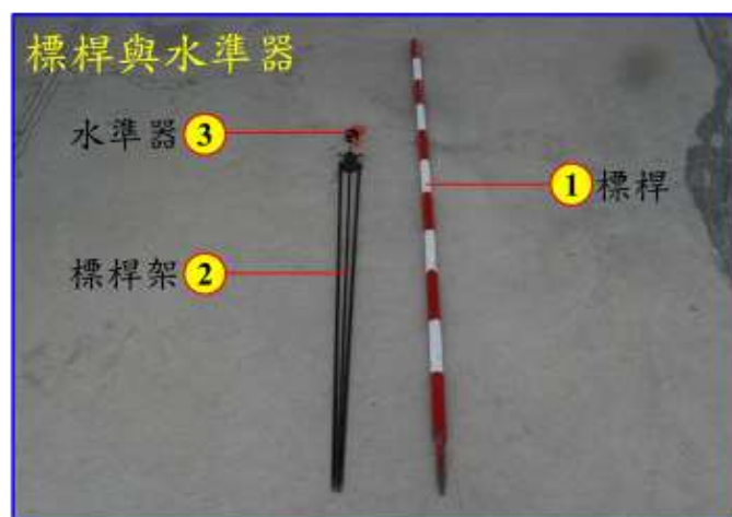
圖 7 原標桿（架）與水準器無輔助夜間作業功能
