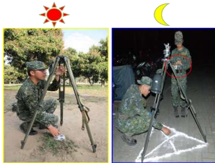
圖 9 M2 方向盤晝、夜間定心差異比較 資料來源：筆者自製
