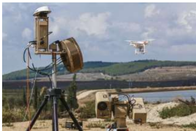
圖 8 無人機鐵穹反無人飛行器系統
