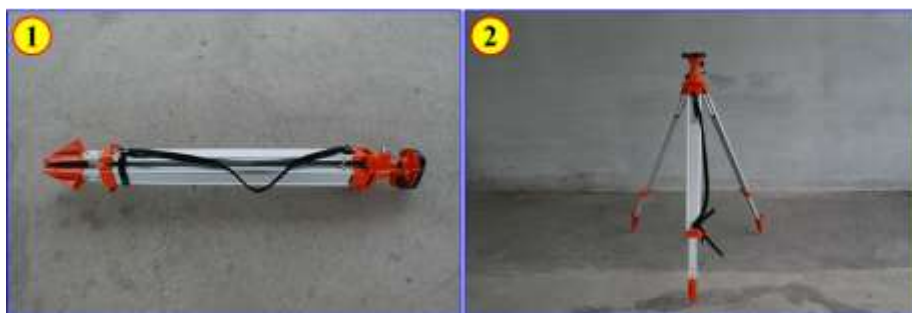
圖 36 通用型儀器腳架與雷射求心基座安裝要領（一）
