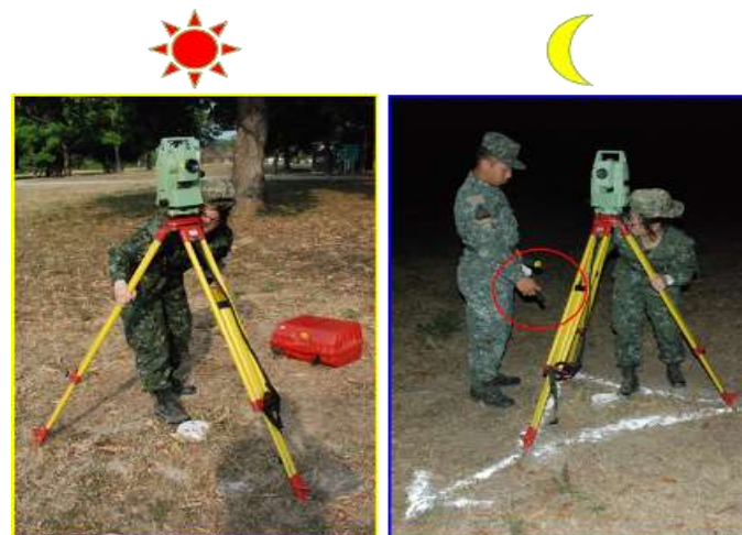
圖 11 徠卡全站儀晝、夜間定心差異比較 資料來源：筆者自製
