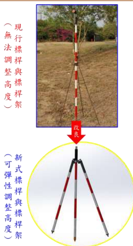
圖 24 本研究研擬設計可調升（調降）之新式標桿（架）
