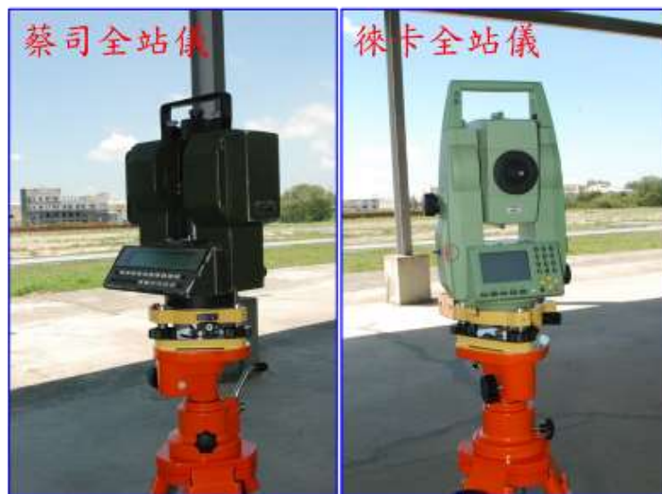
圖 40 蔡司與徠卡全站儀亦適用於通用型儀器腳架與雷射求心基座
