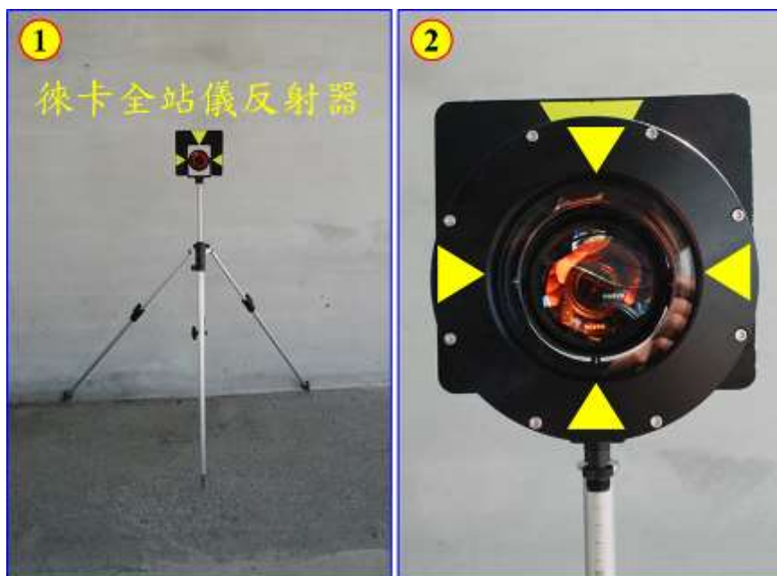
圖 46 反射稜鏡燈安裝要領（徠卡全站儀）
