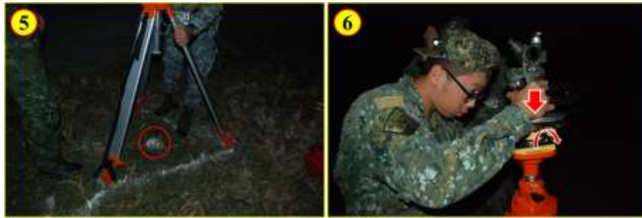
圖 38 通用型儀器腳架與雷射求心基座安裝要領 (三)
