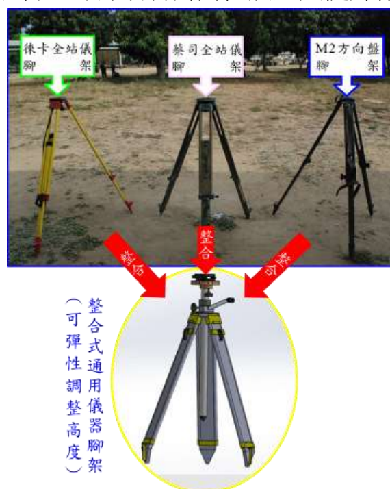
圖 23 本研究研擬設計可調升（調降）之新式儀器腳架
