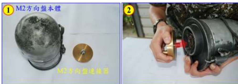
圖 34 M2 方向盤與連接器安裝要領（一）
