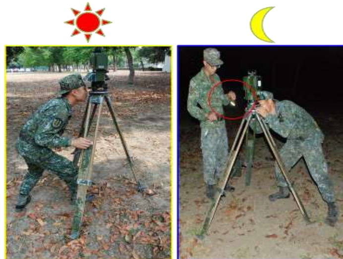
圖 10 蔡司全站儀晝、夜間定心差異比較 資料來源：筆者自製
