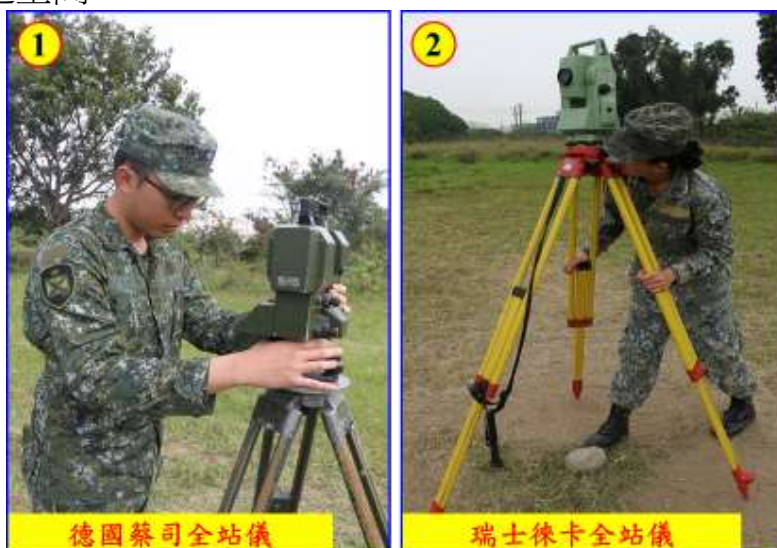
圖 5 蔡司、徠卡全站儀示意圖
