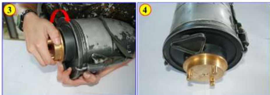
圖 35 M2 方向盤與連接器安裝要領（二）
