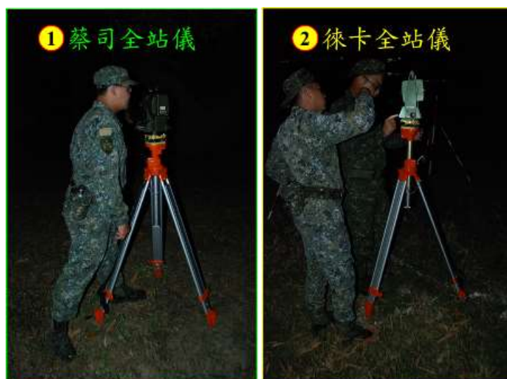
圖 53 完成「全站儀」器材整置示意
