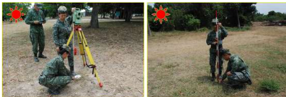
圖 17 晝間使用捲尺量取器材與覘標高度示意圖
