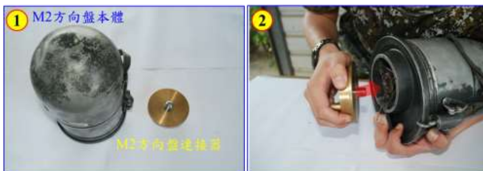
圖 34 M2 方向盤與連接器安裝要領（一）
