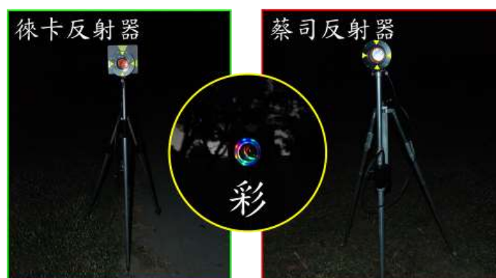
圖 48 「稜鏡燈」燈光模式示意圖
