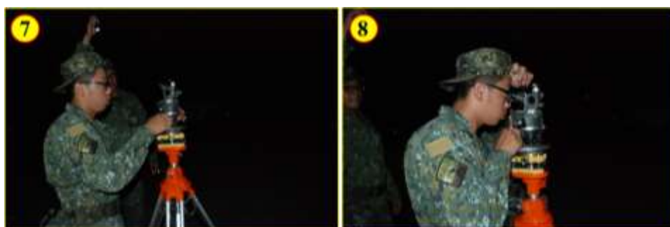
圖 39 通用型儀器腳架與雷射求心基座安裝要領 (四)
