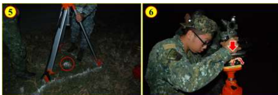
圖 38 通用型儀器腳架與雷射求心基座安裝要領 (三)
