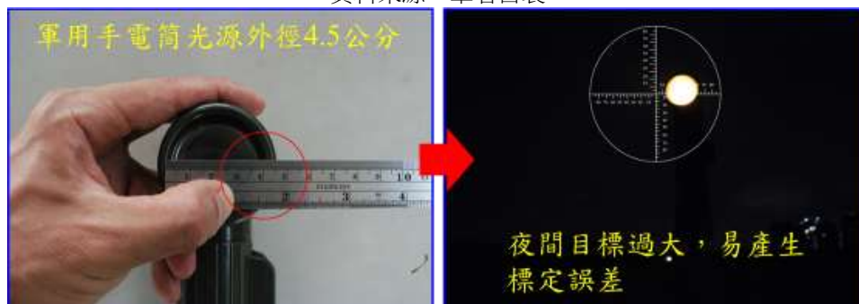
圖 15 以「軍用手電筒」替代「標桿燈」易產生作業誤差
