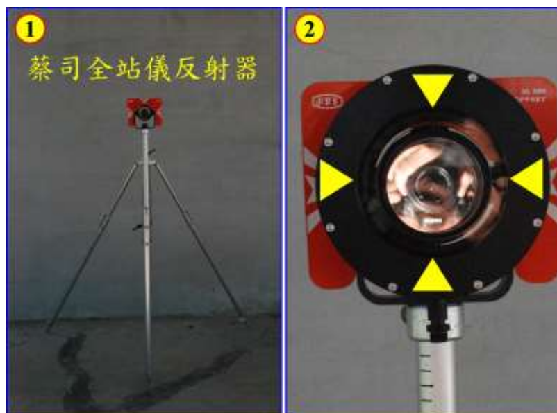
圖 44 反射稜鏡燈安裝要領（蔡司全站儀） 資料來源：筆者自製
