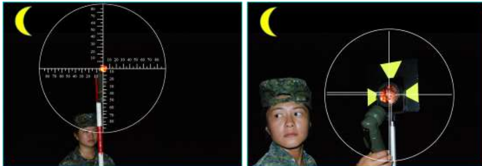
圖 14 夜間標定標桿與反射稜鏡示意圖
