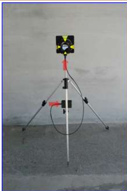
圖 47 完成徠卡全站儀「反射稜鏡燈」整置示意圖
