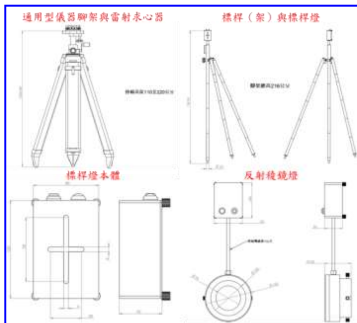
圖 25 「砲兵夜間測地輔助器材」研製設計圖（單位：公厘）
