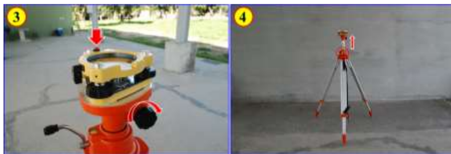
圖 37 通用型儀器腳架與雷射求心基座安裝要領（二）
