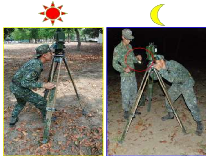
圖 10 蔡司全站儀晝、夜間定心差異比較 資料來源：筆者自製
