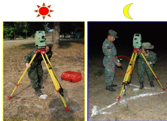
圖 11 徠卡全站儀晝、夜間定心差異比較 資料來源：筆者自製
