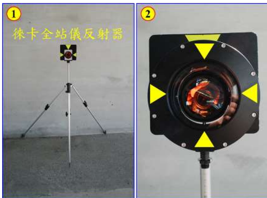
圖 46 反射稜鏡燈安裝要領（徠卡全站儀）
