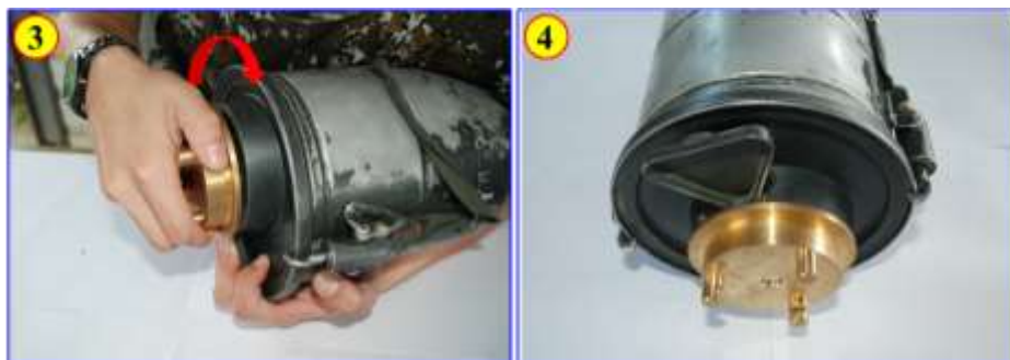
圖 35 M2 方向盤與連接器安裝要領（二）
