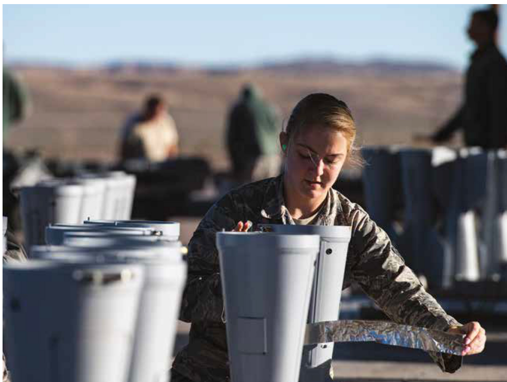
2019年3月13日，在內華達州奈里斯(Nellis)空軍基地，第57彈藥中隊的士兵為BDU-50惰性炸彈的BSU-33錐形尾翼組件固定門蓋。
