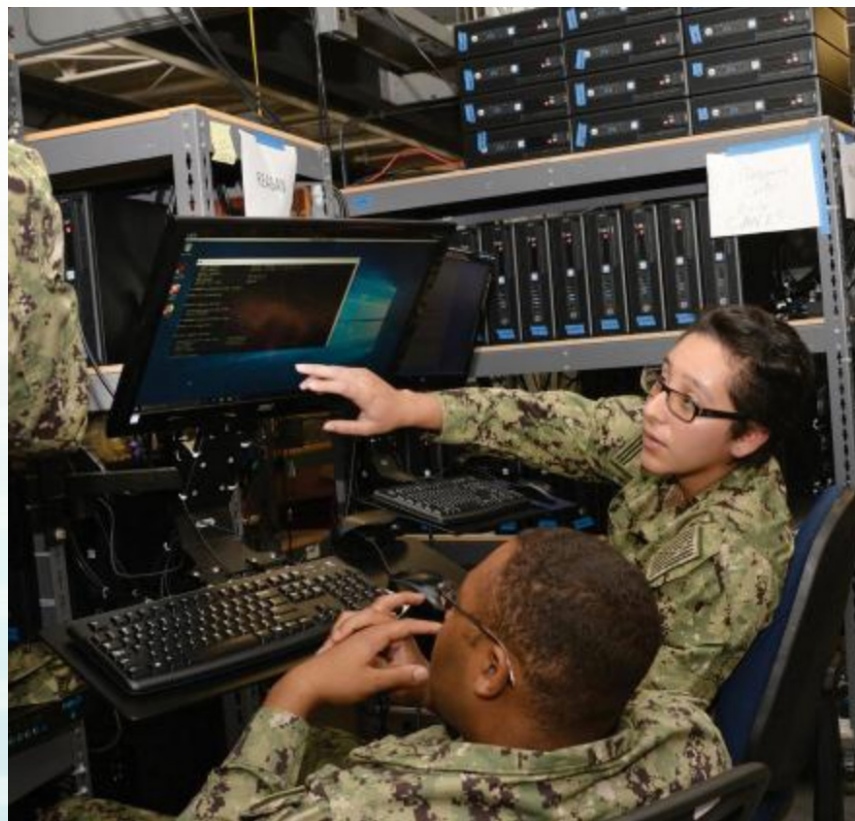
服務於航艦雷根號(USS Ronald Reagan)的海軍資訊系統技術員，負責統合式艦艇網路與企業服務(CANES)系統中，超過1,500部艦上電腦工作站之維護工作。美海軍刻正以現有技術，將統合式艦艇網路與企業服務系統，與其他艦用網路整併於單一運算設備。(Source: USN/ Rick Naystatt)
