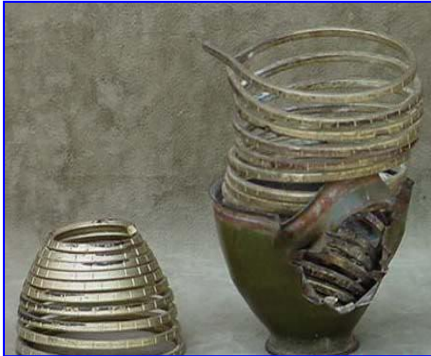
圖四：M26 式手榴彈內部結構
