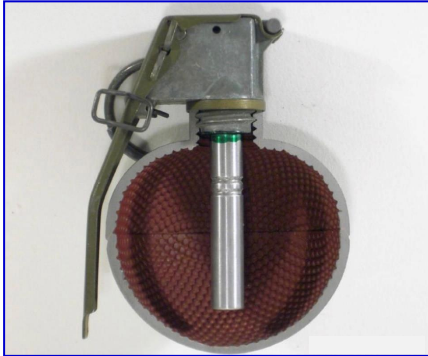
圖三：M67 式手榴彈內部結構
