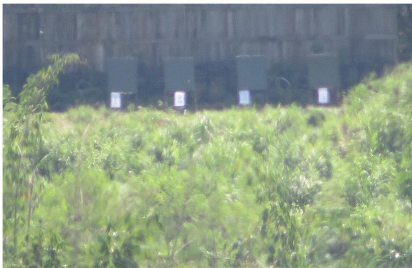
圖二十四 1000 公尺熱擾流影響觀瞄效果示意圖
