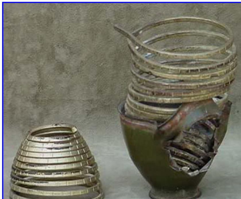
圖四：M26 式手榴彈內部結構
