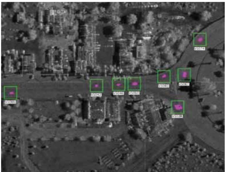
圖4. 可對移動中目標鎖定顯示的合成孔徑雷達實測影像。
