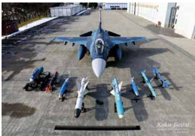
圖2 日本航空自衛隊的F-2A超音速多功能戰鬥機，此機是典型「美日同盟」架構下的時代產品，日本要求「純自製」含量達到60%以上。圖示武裝為ASM-2反艦飛彈(2種導引模式均可由此機投射)與其他空對空飛彈和20公厘砲彈。
