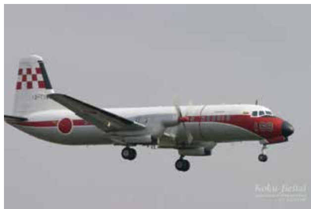
圖1 日本航空自衛隊使用的YS-11FC電子導航查核機已於2021年3月17日除役，此一構型是YS-11系列機身改裝潛力的最佳化呈現。
