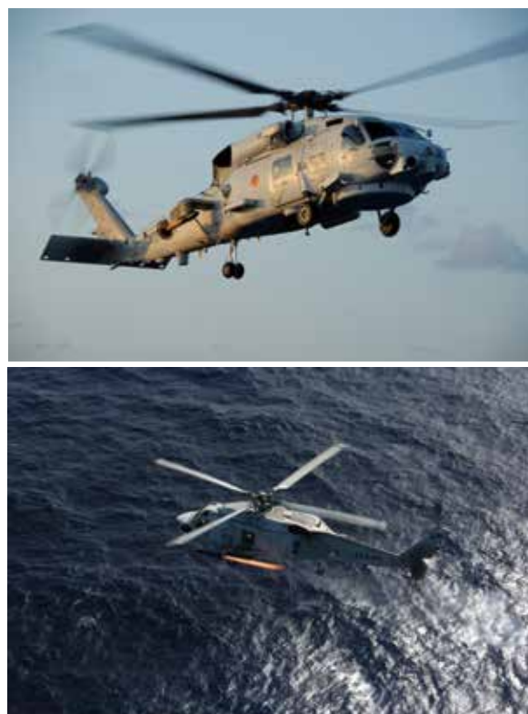
圖7~8 日本海上自衛隊SH-60J性能升級版和SH-60K反潛直升機，後者已能發射短程反艦飛彈，具有對海岸目標的反制能力。
