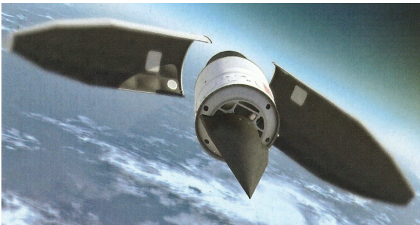
畫家對彈道飛彈投放HGV彈頭的想像圖。此插圖與DARPA的「戰術助推滑翔」(Tactical Boost Glide, TBG)計畫有關，但可以作為此概念的一般性描述。(Source: Lockheed Martin)
