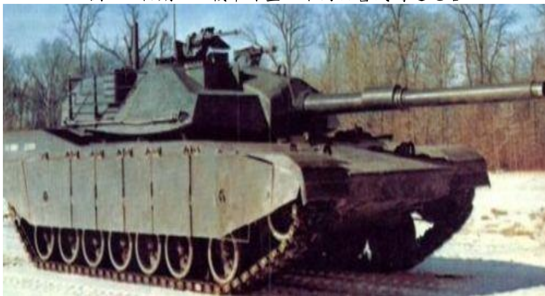
圖 4、初期 M1 戰車外型，不同於舊式鑄造砲塔
