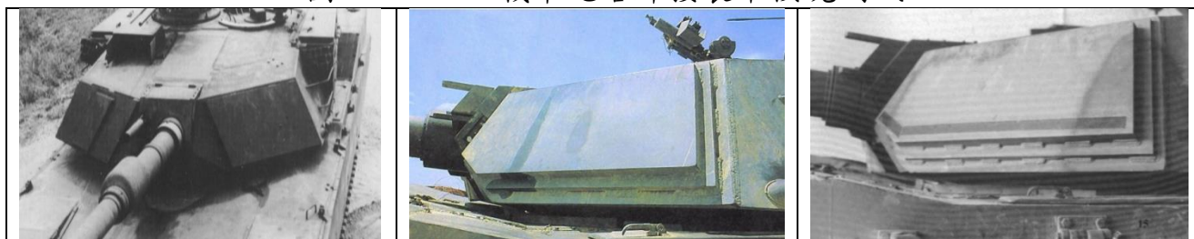
圖 7、M1E1 戰車砲塔焊接裝甲模塊測試
