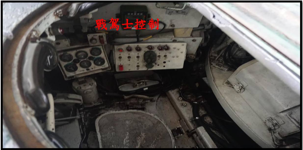
圖 9-戰車駕駛室戰駕士控制盒安裝實景圖（以 M60A3 戰車為例）
