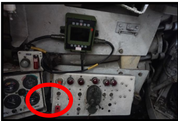
圖 10-戰車駕駛室兵工導線接線座位置示意圖（以 M60A3 戰車為例）
