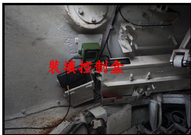
圖 8 裝填兵控制盒安裝實景圖 （以 M60A3 戰車為例）
