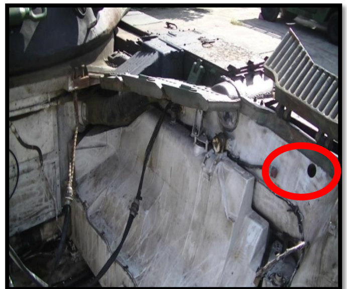
圖 15-戰車後方引擎室穿孔圖 (戰車引擎拆卸)
