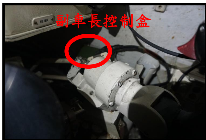
圖 7 副車長控制盒安裝實景圖 （以 M60A3 戰車為例）
