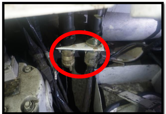
圖 11-戰車駕駛室兵工導線接線座實景圖（以 M60A3 戰車為例）
