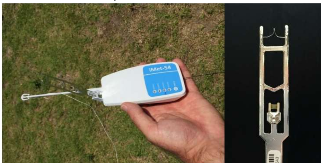
圖 5 iMet-54 無線電探空儀 1680MHZ
