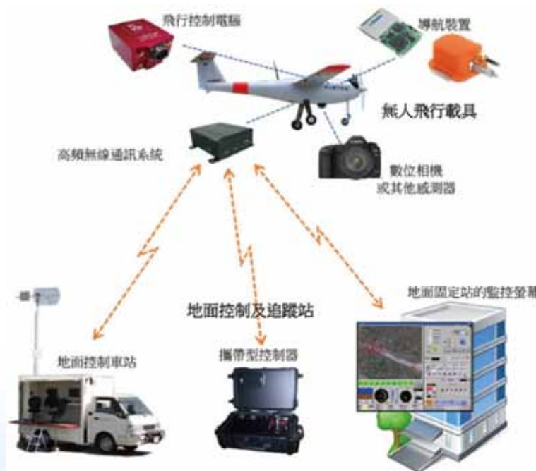
圖3 無人航空系統(UAS)的基本組成
