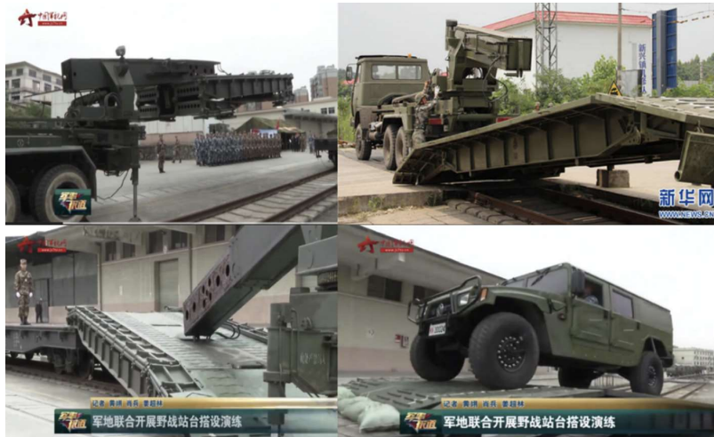
圖三 新型野戰月臺車搭設
