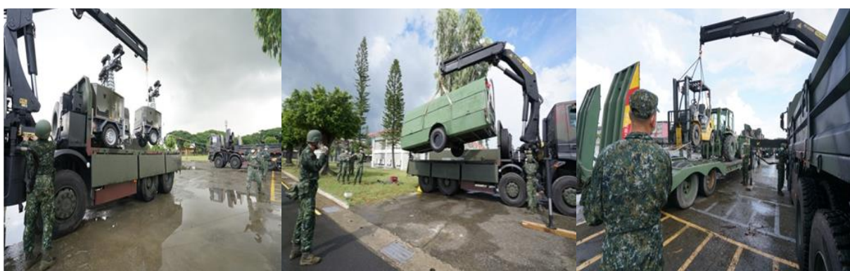
圖 1 多用途橋車吊掛作業(工兵小型機械)
