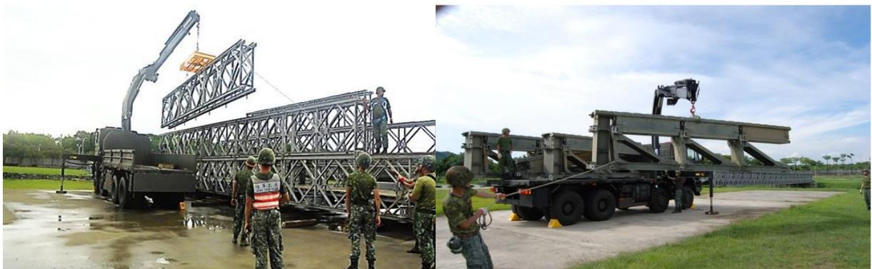
圖 3 多用途橋車吊掛作業(M2、MGB 機械協建)
