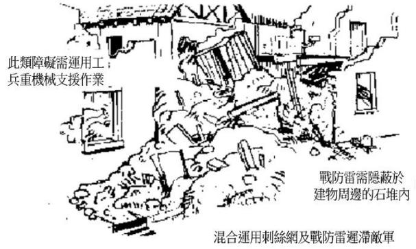
圖 8-7 礫石障礙設置示意圖
