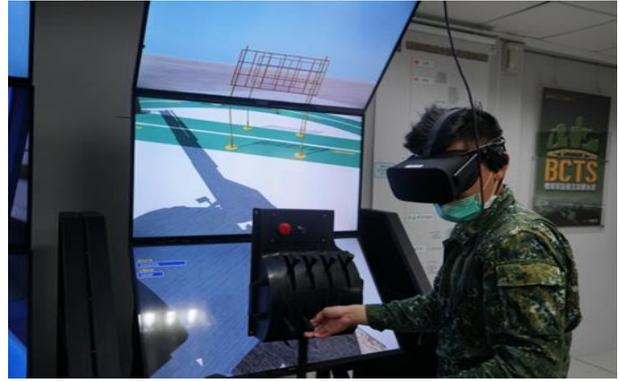
圖 39 模擬器堆高機、吊臂考照場地訓練操作示意圖
