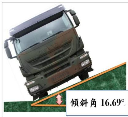
圖 18 側坡安全傾斜角<sup>7</sup>
