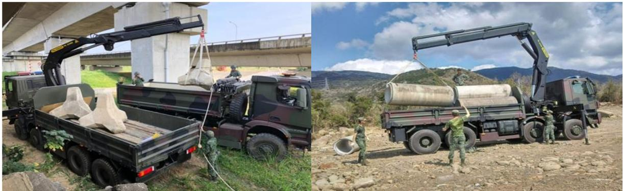
圖 2 多用途橋車吊掛作業(大型阻材-消波塊、涵管)
