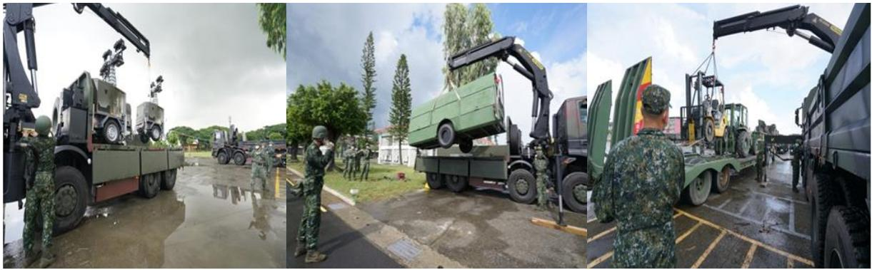
圖 1 多用途橋車吊掛作業(工兵小型機械)
