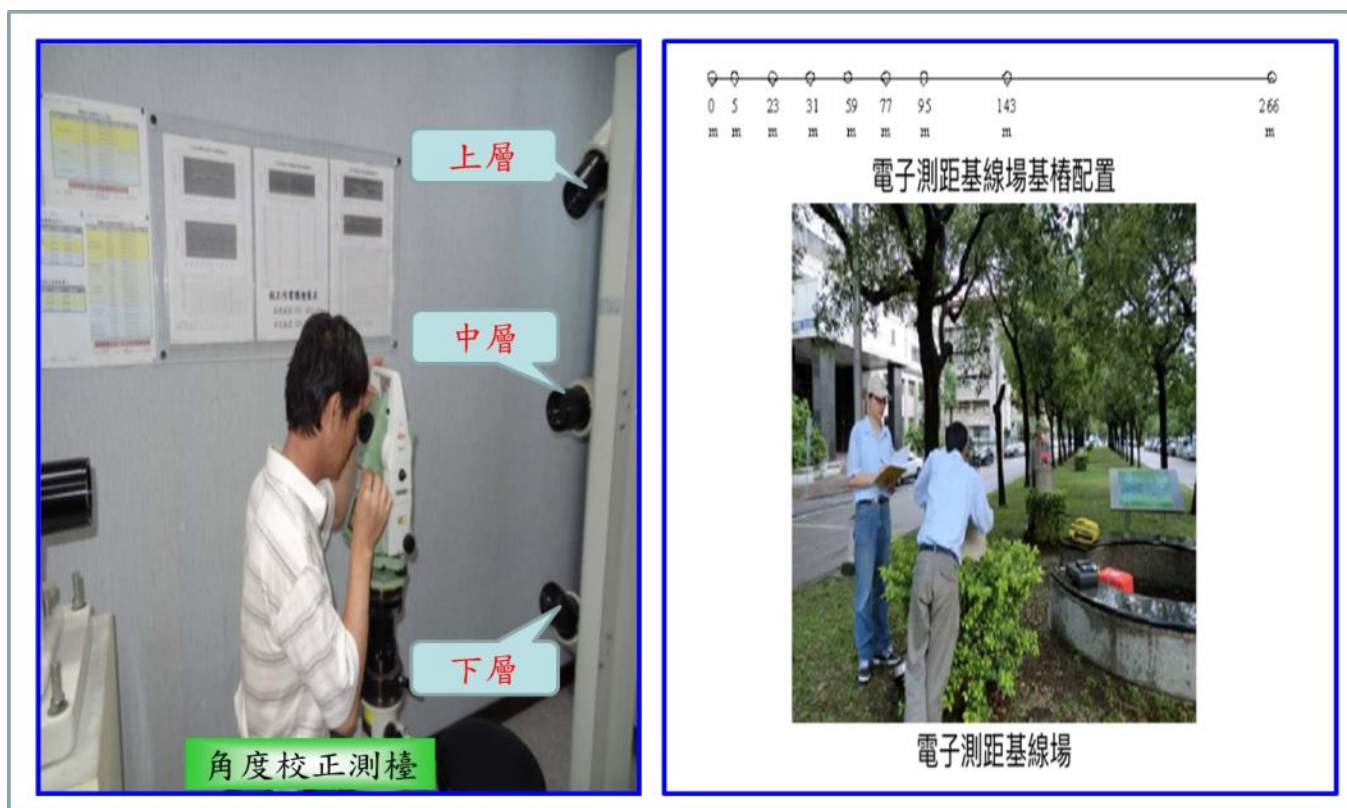
圖十二 角度及距離校正場
