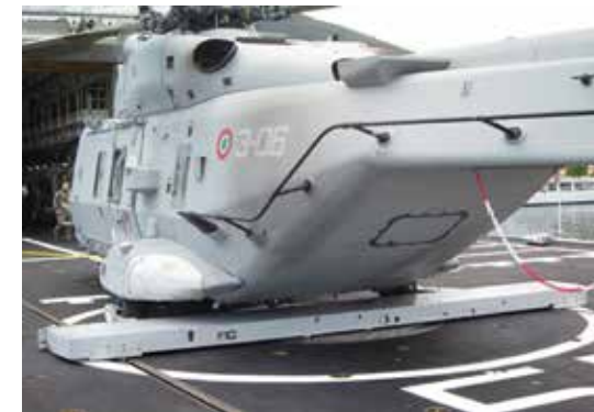
TC-ASIST 系統的捕捉器，可注意捕捉位置為直升機之機輪而非 ASIST 所需之探針。
