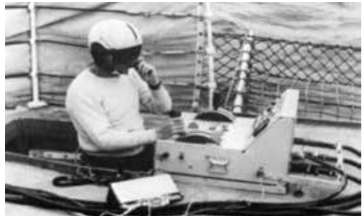
降落指揮員 (Landing Control Officer, LSO) 於甲板上負責操控 Bear trap 裝置
