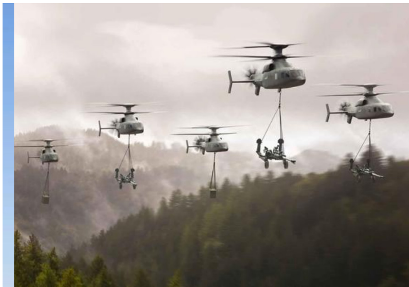
相較於貝爾公司的V-280所採用之傾轉旋翼設計，塞考斯基與波音公司的「挑戰者X」(右上為其多機編隊的概念圖)則採用複合直升機設計，於其前方配有兩組直升機的主旋翼，尾部則為推進螺旋槳。(Source: US Army/Luke J. Allen and Sikorsky-Boeing)
