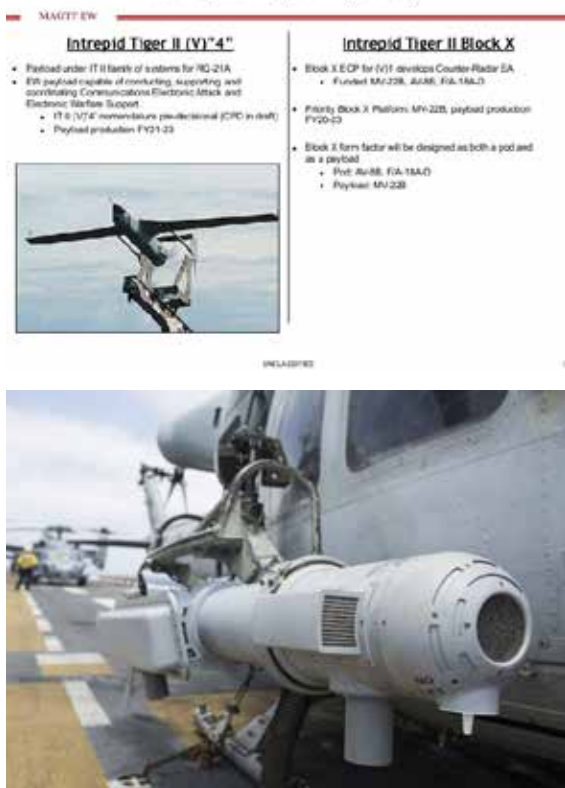
圖2~3 美國陸戰隊正在為未來海上航空力量研製的「無畏虎 II」機載通信與電戰英艙，以期暫時取代EA-6B雷達干擾飛機除役之後的戰力空隙，圖示為該英艙的各種研改構型，以便於讓各現役機種搭載使用。
