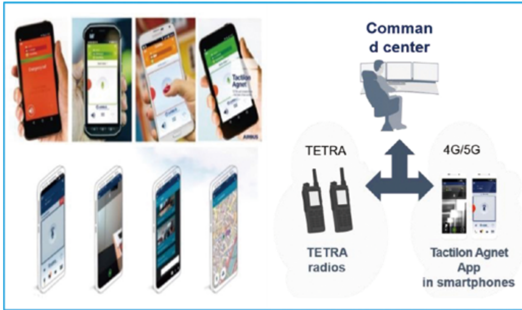
圖4 AIRBUS MCPTT APP -Agnets操作架構示意圖
