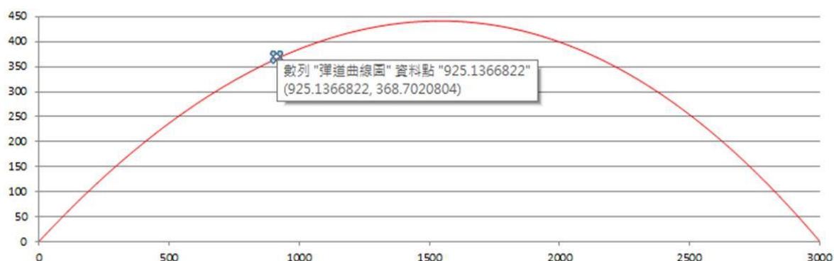
圖 14 可瞭解彈道上任一點之水平距離及彈道高度
