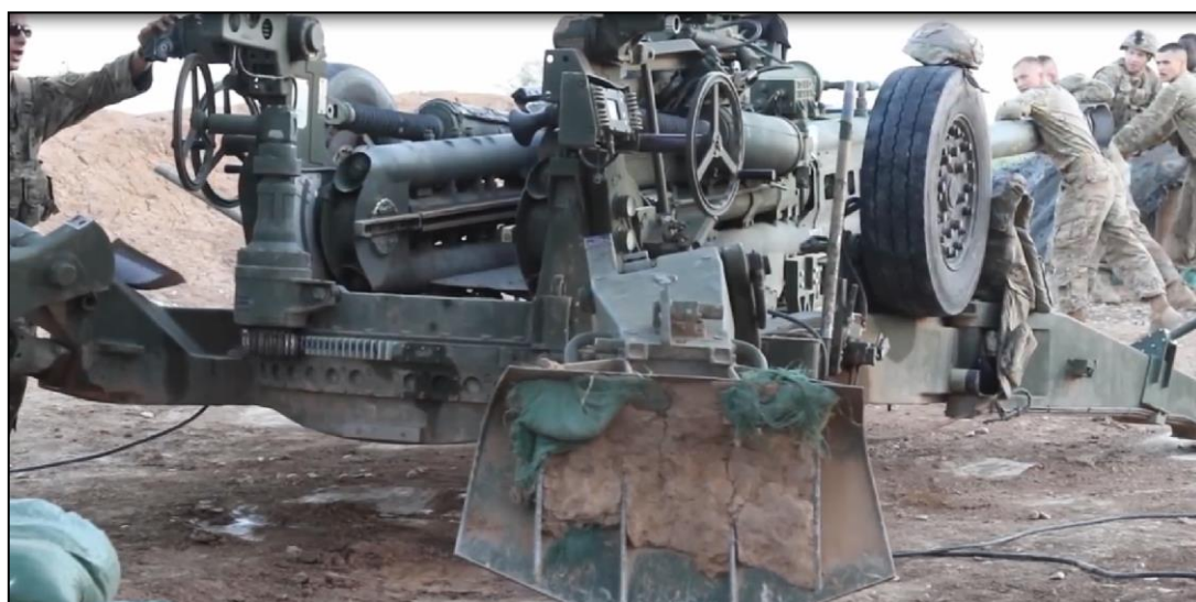
圖13 瞄準手依「瞄準手顯示與控制面板」指揮將火炮微調至射擊方向
