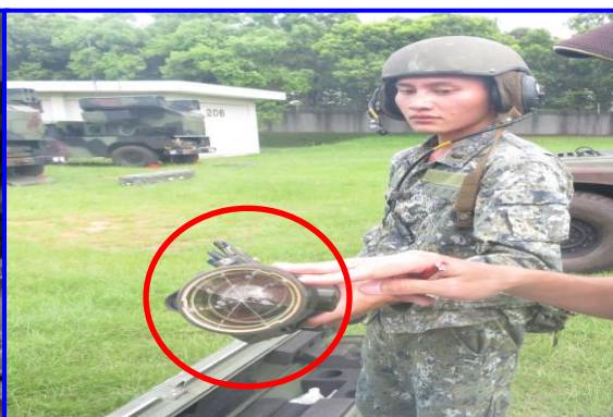
圖 11 電子訓練彈前視窗破損
