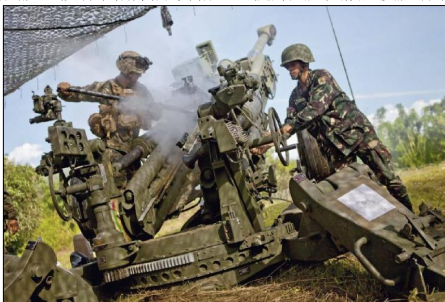
圖 10 安裝 LINAPS 系統之 M777A2 式 155 公厘榴砲
