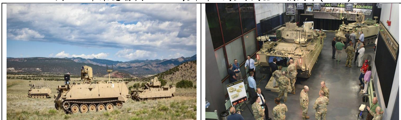
圖 8、布萊德雷與 M113 裝甲車改裝的機器人戰鬥車(RCV)
