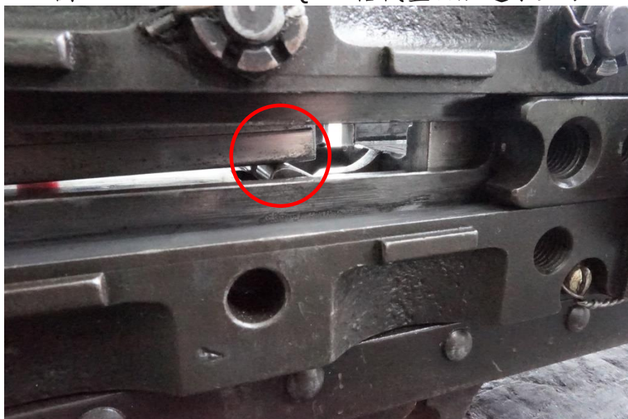
圖 41、M2-HB、M2-QCB 槍機置於加速子上方
