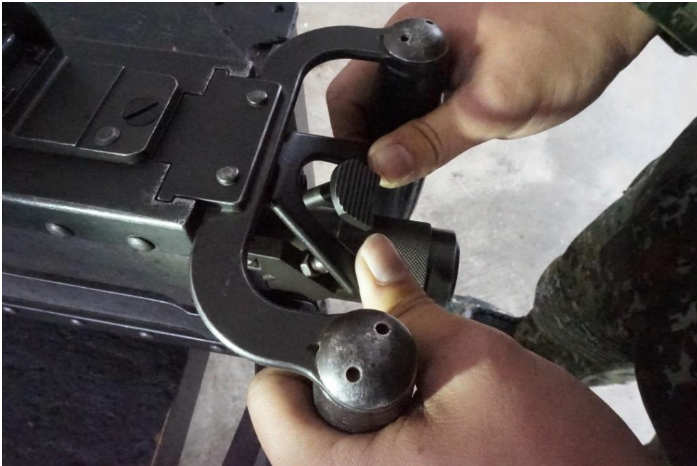
圖 45、按壓扳機實施擊發，不能擊發為正常
