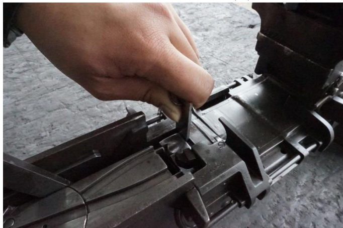
圖 63、將 0.116 樣鈹規置入左耳軸與槍管接套間
