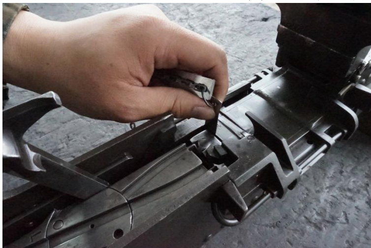
圖 67、將 0.020 樣鈹規置入左耳軸與槍管接套間
