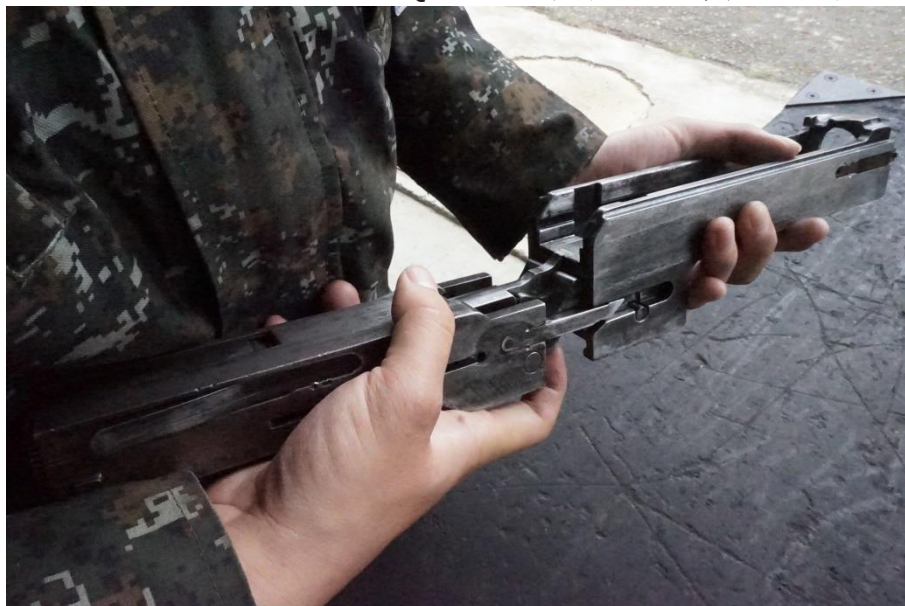
圖 40、M2-HB、M2-QCB 分解滑油緩衝管及接套
