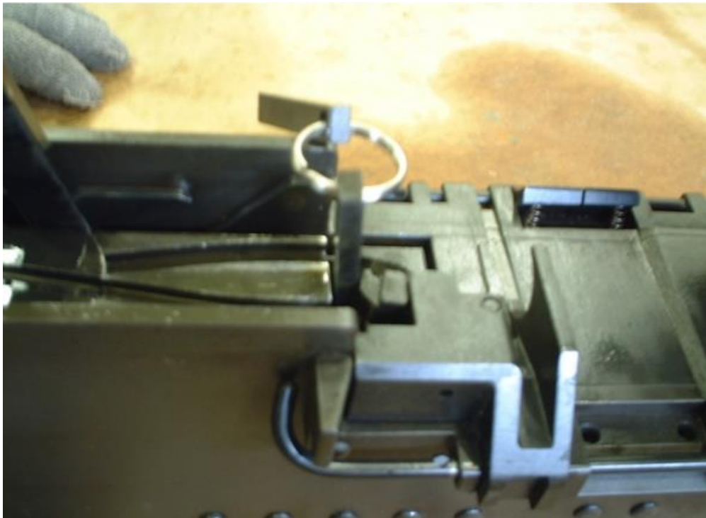
圖 69、將 0.202 樣板規能置入 T 字槽為正常
