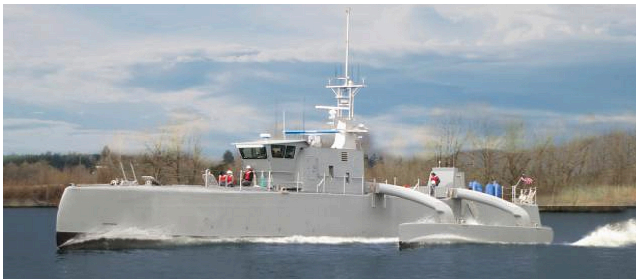
超大型自主無人系統比有人載臺更具成本效益。圖中反潛作戰持續追蹤無人載具每艘成本2,500萬美元，可以從水平線外進入布雷水域，以12節速度可航行1萬哩。(Source: DARPA)
