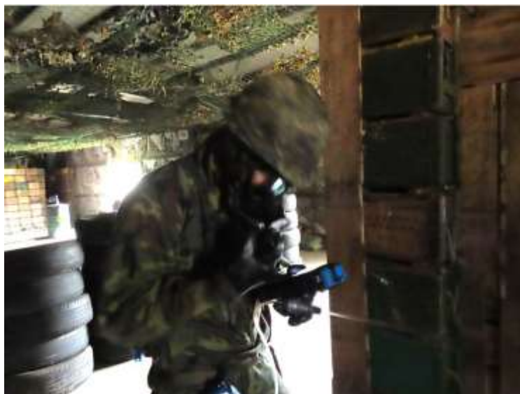
圖 6 於每處入口觀察 Chempro100(i)化學戰劑偵檢器
