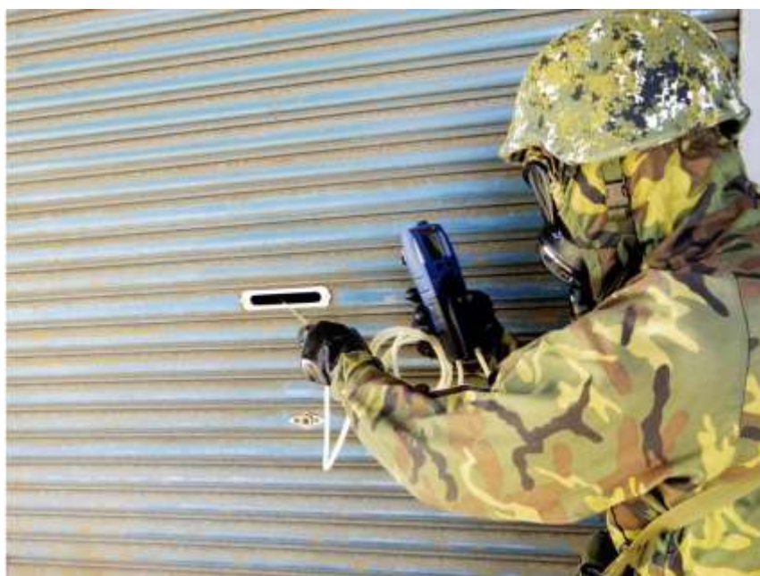
圖4 以PHD6氣體偵測器偵測示意圖
