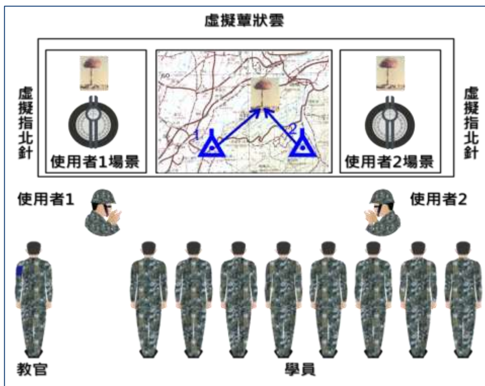
圖 3 核爆狀況下之前方交會法地面零點標定示意
