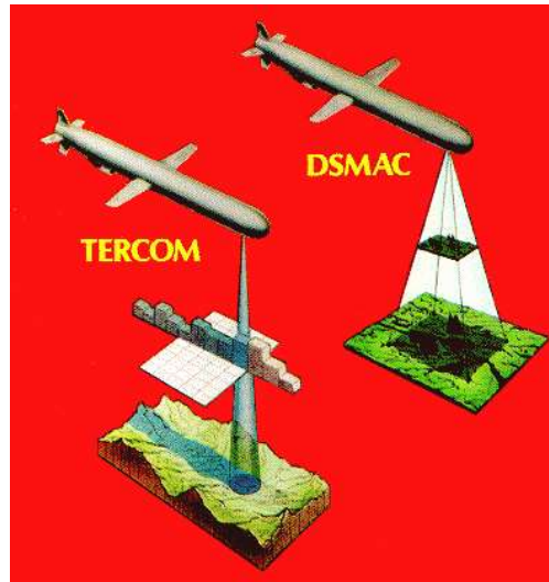
圖 5 地形等高線匹配雷達導引及數位場景匹配關連系統運作示意圖
