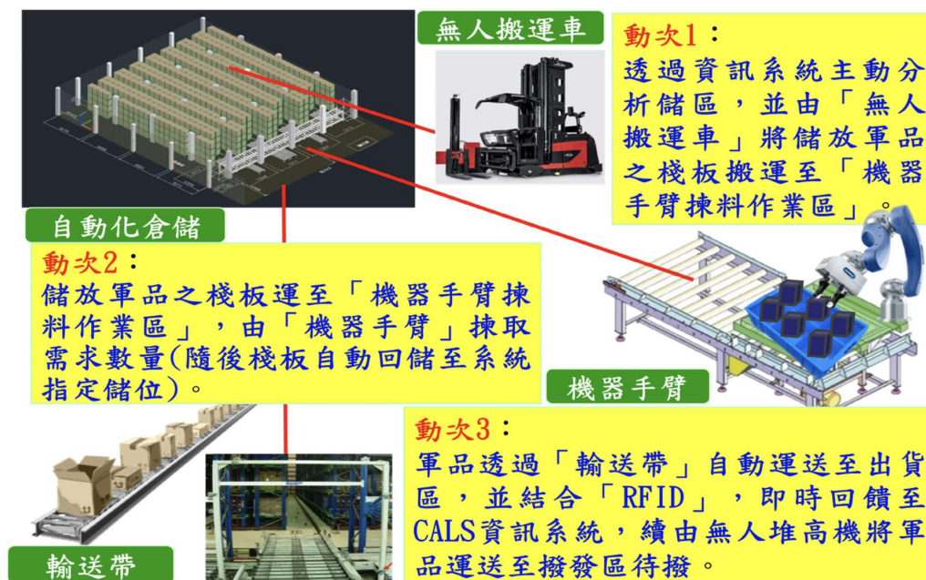
圖八 兵整中心智慧倉儲運作示意圖
