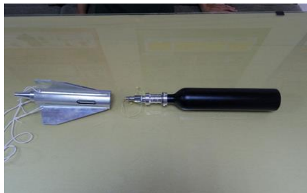
圖 19 安裝氣動式牽引彈頭 資料來源：作者自行拍攝。
