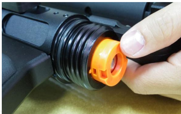
圖 18 排雷發射器安裝導爆管 資料來源：作者自行拍攝。
