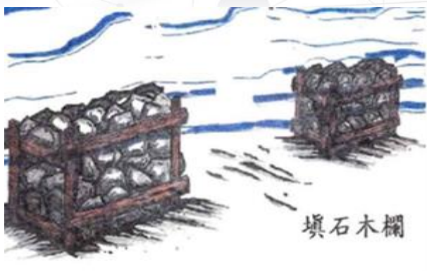
圖 16 填石木欄示意圖
