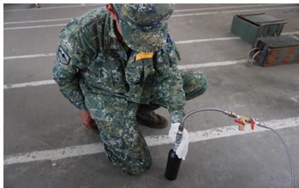
圖 16 氣動式牽引彈頭充氣 資料來源：作者自行整理。
