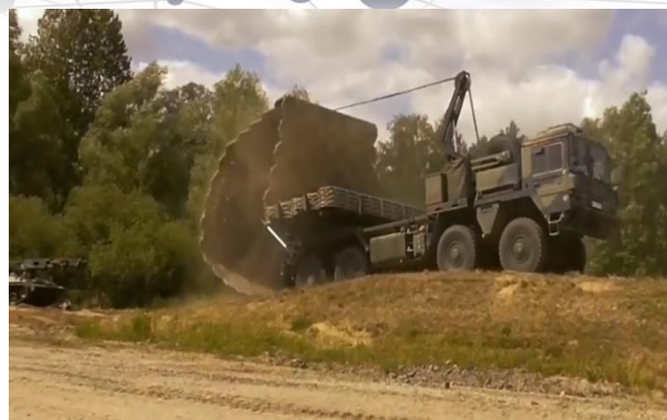
圖 28 共軍鋼板機動蒞 資料來源：YOUKU，工程兵修路，簡單又粗暴，8 輪卡車直接往地上扔下一卷卷鋼板！， https://v-wb.youku.com/v_show/id_XNDY1MjkxNjg4MA==.html ，檢索日期，西元 2020 年 5 月 28 日。
