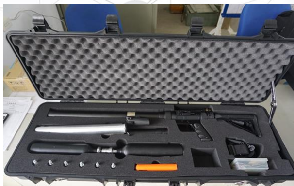
圖 4 氣動式可重複發射排雷器主體
