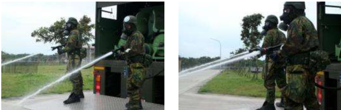
圖 3 MD-105 重型消毒車消除作業
