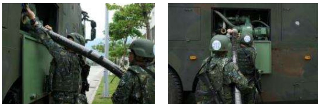
圖 1 MD-105 重型消毒車汲水作業
