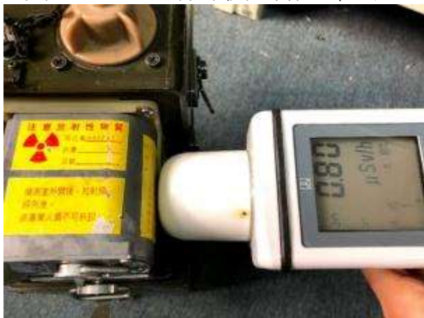
圖 2 M8A1 射源模組劑量率測量
