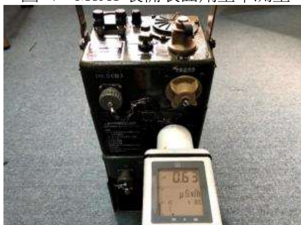
圖 4 M8A1 裝備表面劑量率測量
