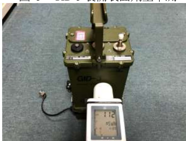
圖 5 GID-3 裝備表面劑量率測
