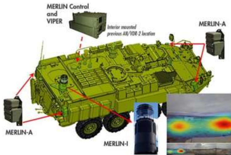
圖 18 車載整合式平台增強型輻射偵測器(VIPER)與車載增強型輻射偵測顯示計量遠程成像網絡(MERLIN)配備於 M1135 史崔克核生化偵檢車
