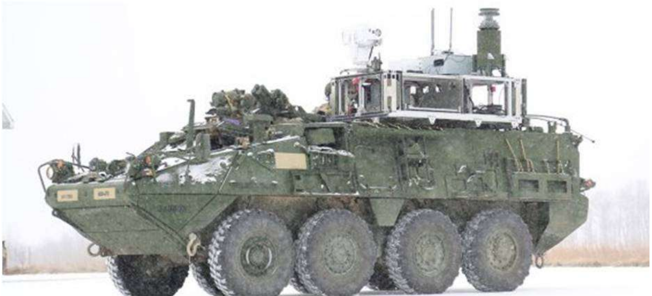
圖 14 配備新型化學偵測感測器組合的核生化偵檢車
