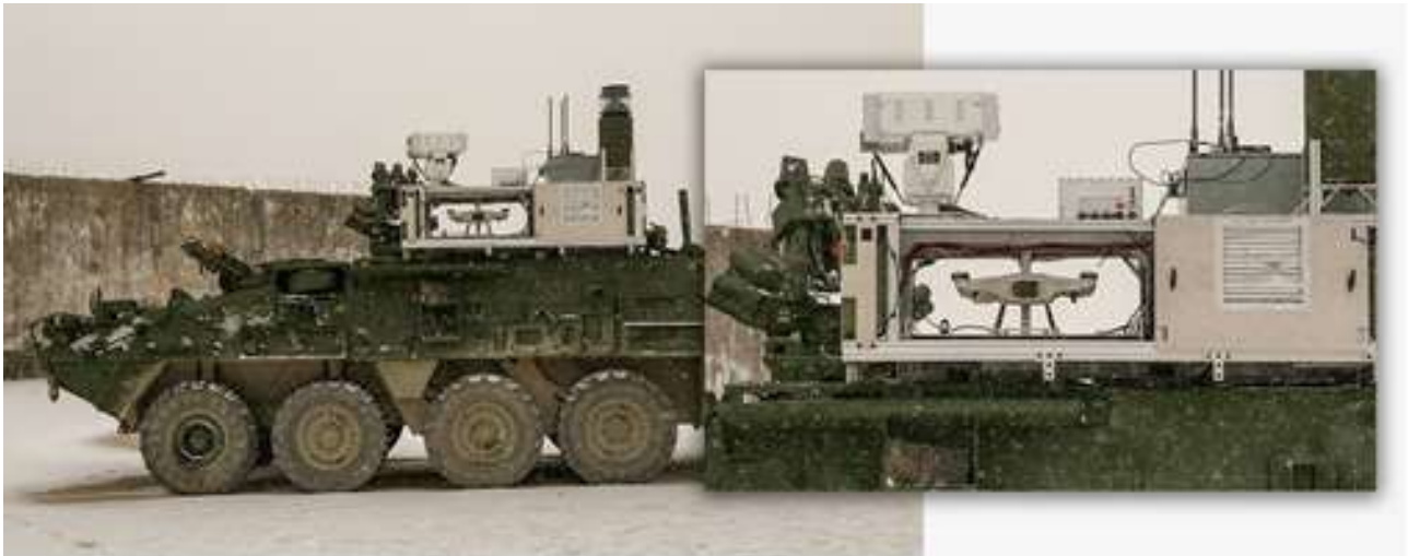
圖 21 史崔克核生化偵檢車感測器套件升級配備之無人駕駛飛行器(UAV)
